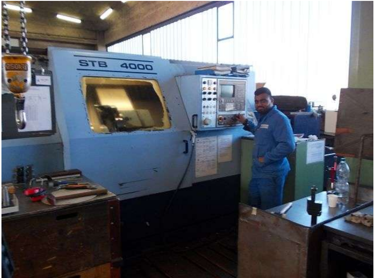
Bild 6: Noch einmal die Maschine vor dem Umbau mit der alten Sinumerik 810T
