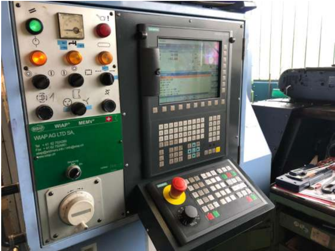
Bild 3 Da die CNC länger ist als die alte, musste auch Schräge nach vorne gemacht werden, was aber den Bedien Komfort auch verbessert.
