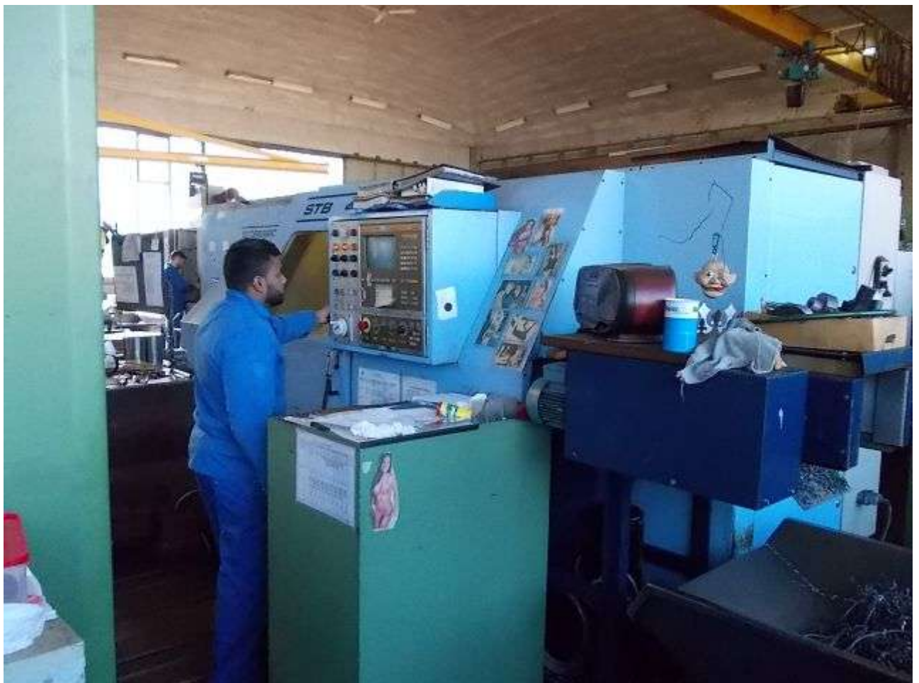
TITEL BILD 1: Storebro STB 4000 CNC Drehmaschine bei Schweizer Kunden im Kanton Bern wird umgebaut auf neue Sinumerik. CNC 810T weg, neue Sinumerik
