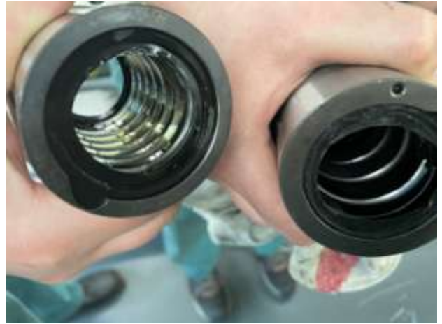
Bild 6.8 Die Mutter rechts ist die alte, die Mutter links ist eine neue Mutter. Der Richtige hat nur einen Lauf auf jedem zweiten Kurs.
