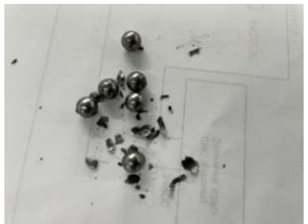
Bild 6.5 So sah es in der Auslenkung aus. Aber die Kugelumlaufmutter hatte noch viel mehr Schmutz drin.
