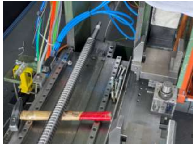
Bild 6.3 Bei der X-Spindel wurde die Kugelumlaufmutter durch den Schmutz blockiert. Dies musste abgebaut werden.
