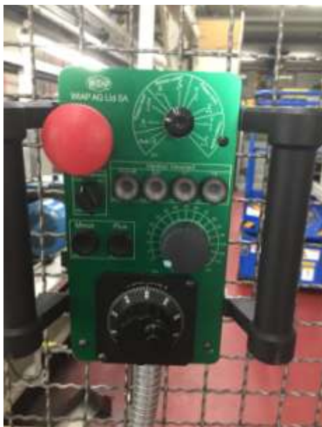
Bild 4.6 Neues externes Bedien Panel nach dem Umbau. Geschützt mit den aufrechten Seitengriffen, wenn es mit den Knöpfen und dem Handrad nach unten auf den Boden fällt.
