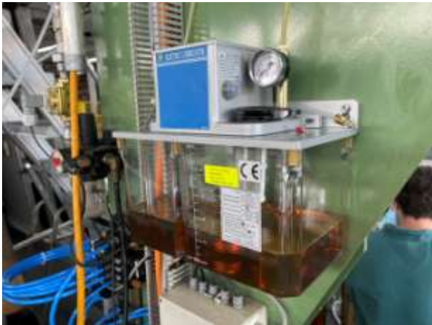
Bild 6.2 Die neue Schmierpumpe mit 4-Liter-Tank und Druckregelung sowie Füllstandsanzeige an der CNC-Steuerung. Diese Pumpe läuft 20 Sekunden lang. Wenn sich in der Zeit kein Druck aufbaut, ist eine Leitung oder eine Dosiereinheit nicht mehr in Ordnung und zeigt einen Alarm auf der CNC an.
