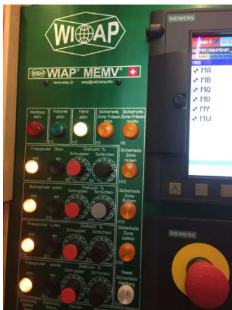
Bild 8 / 9. Einzelpotentiometer für die Einstellung aller Drehzahlen der Fräs- und Bohrspindeln. Schrupp- und Schlichtgeschwindigkeit programmierbar über die CNC.
