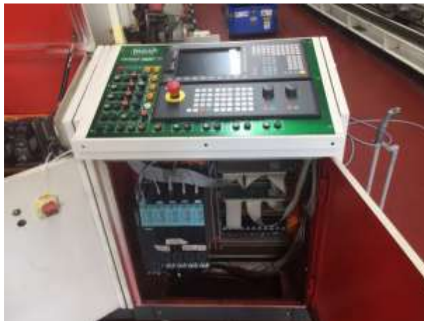
Bild 6. Unter dem Steuerchrank sind die 4 Achsmodule angeordnet, welche jeweils ein Achsenpaar der 4 Gruppen ansteuert.
