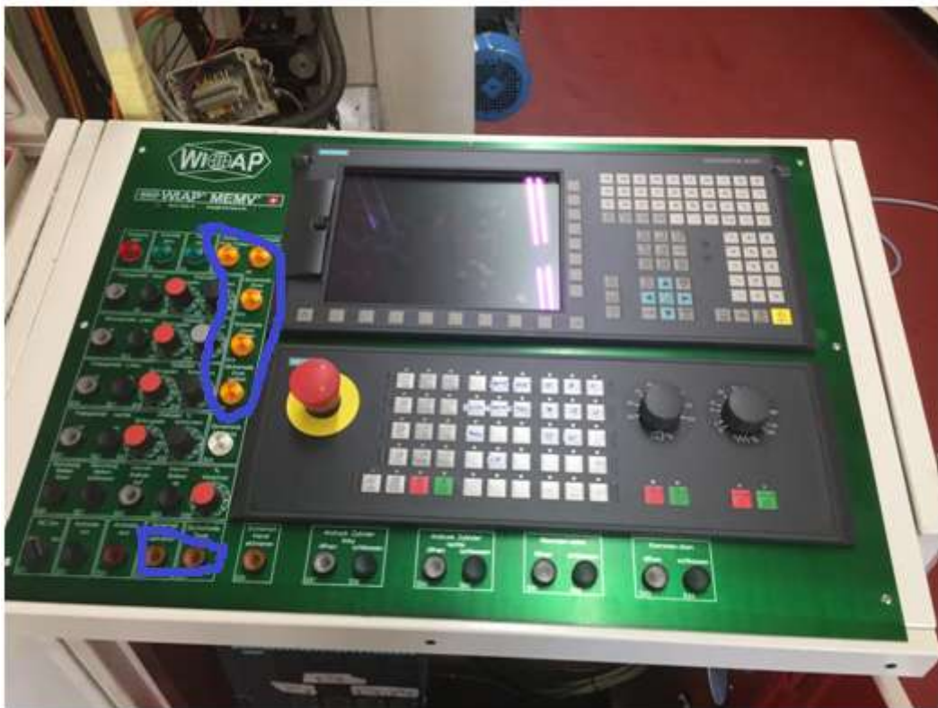
Bild 3: Oben (blau markiert) die Anzeige, wenn eine der 4 Schutzzonen betreten wurde. Unten (blau markiert) Schutzzonen löschen/rücksetzen
