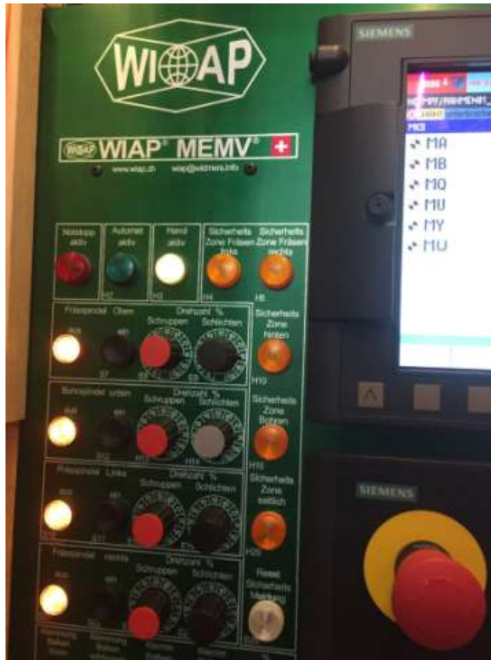
Bild 2. Am Bedienpanel der CNC-Steuerung sind alle Schutz-zonen mit Leuchten versehen, so dass, wenn Personen Zonen betreten und die Anlage in einen Stopp geht, sofort erkannt wird, welche Zone den Alarm auslöste. Nur mit Löschen des Alarms kann die Anlage wieder gestartet werden.
