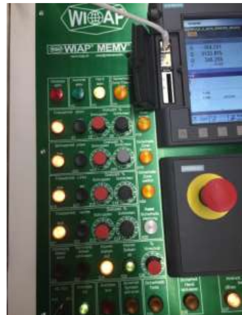
Bild 8 / 9. Einzelpotentiometer für die Einstellung aller Drehzahlen der Fräs- und Bohrspindeln. Schrupp- und Schlichtgeschwindigkeit programmierbar über die CNC.
