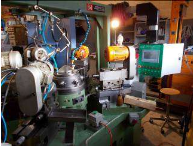
Bild 5.1 Hier wurde eine Rundtakt Maschine mit einem HMI gemacht, das reicht oft, wenn keine CNC Steuerung nötig ist, zum Beispiel wenn die Achsen nur auf Endschalter Positionen fahren müssen
