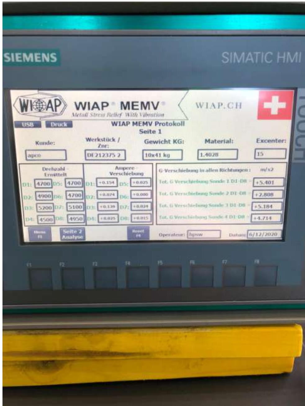
Bild 3.2: Hier wird am HMI der ganze Prozess angezeigt der danach abgespeichert werden kann für die Protokollierung. Wofür sich vor allem die Qualitätssicherung interessiert
