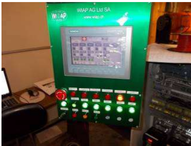
Bild 5.2 Das Bedien Panel ist ein einfacher Aufbau die WIAP hat hier gleich ein Paar solche Frontplatten auf einmal an Lager bestellt, dass Umbauten auch schnell gehen können.
