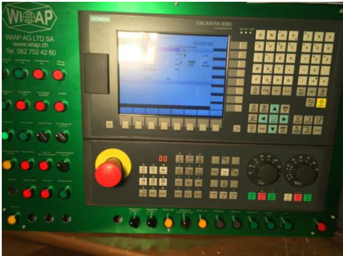
Bild 1: 4 Achsen CNC Sinumerik 808 Hobel Maschine
