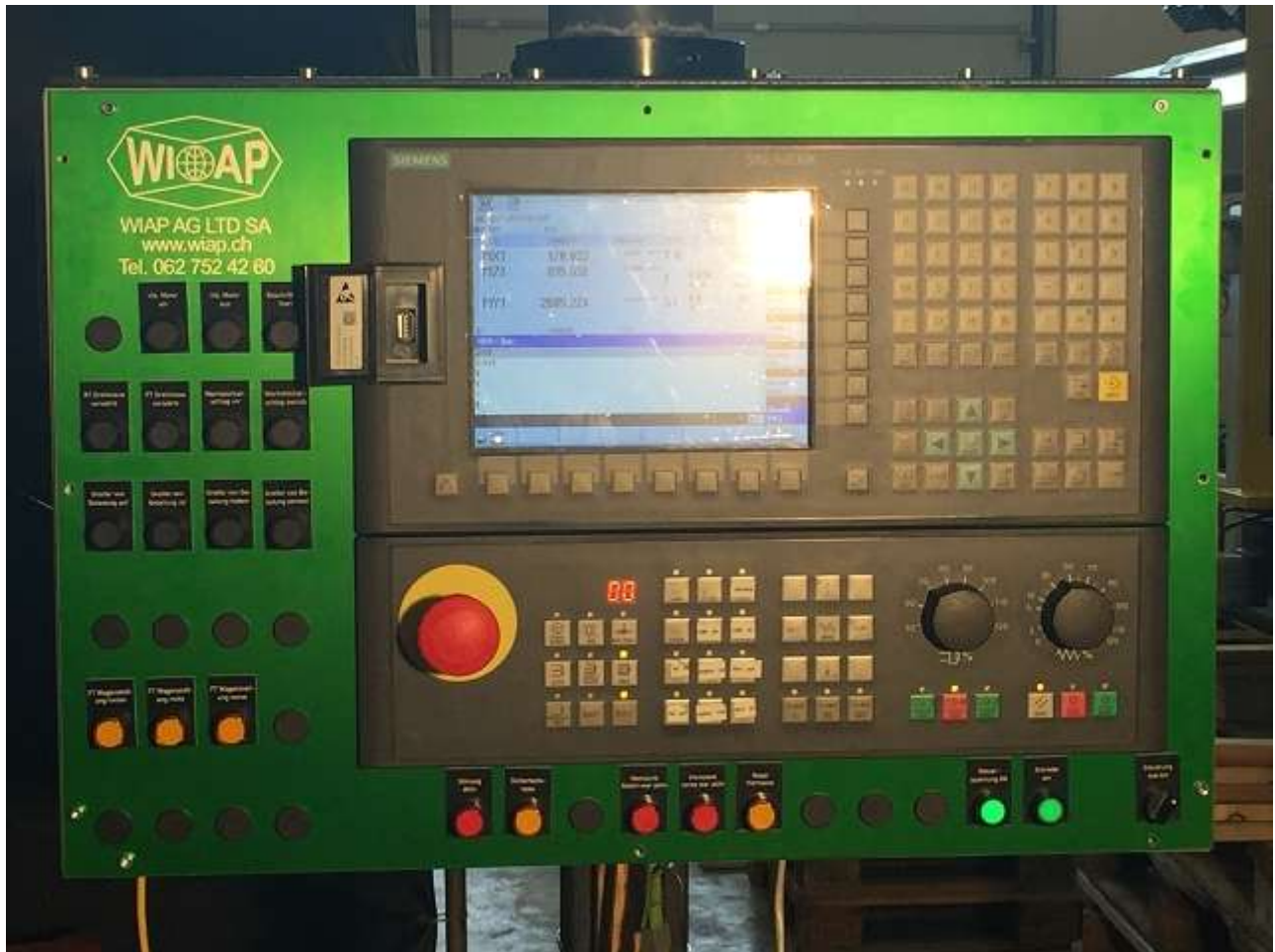
Bild 2: 4 Achsen CNC Sinumerik 808 WIAP CNC Schälmaschine mit Lader als Automation.
