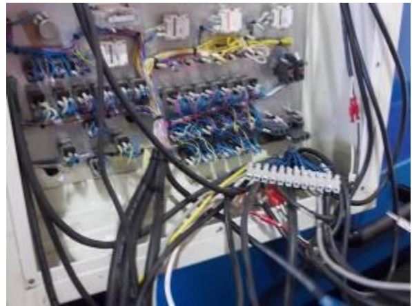
P4) Innenansicht des alten Panel. Auffallend ist, dass hier ein 50-poliges Kabel die CNC vorne zur CNC hinten verbindet. Wir ersetzen das mit einem Profibus Kabel, 2-polig.
