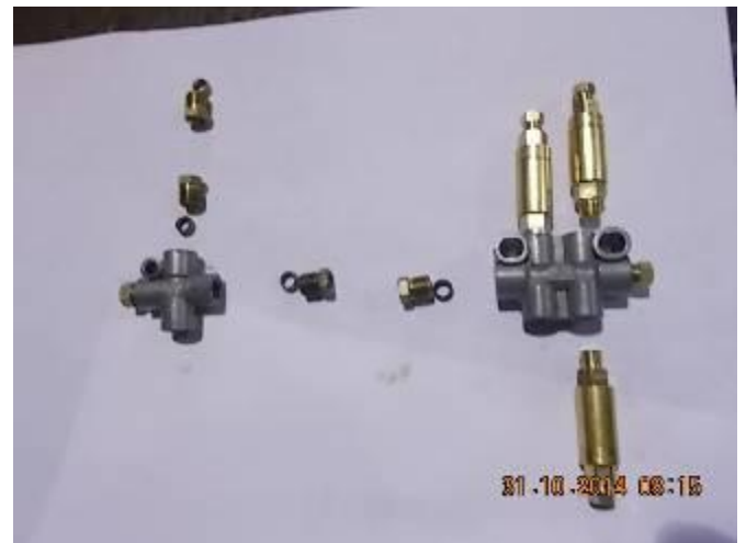
P41) Schmierungsumbau. Die Kugelrollspindel bekommt eine Doppelmenge Oel.
