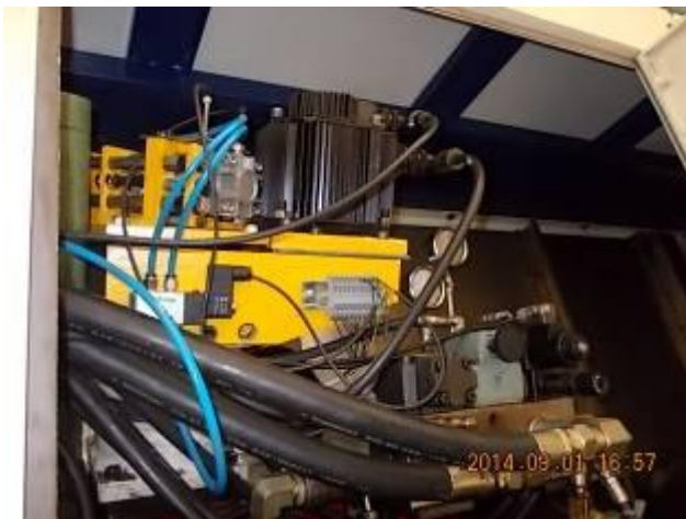
P38) Wenig Platz für die Anordnung bei der 60° Schrägbett CNC Drehmaschinen Anordnung.
