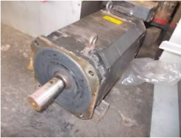
P12) Der Fanuc Hauptspindelmotor sieht hier in Angola nach kurzer Einsatzzeit, sehr mitgenommen aus. Das Klima ist hier sehr angriffig. Lüfterräder zerbröckeln in der Regel.
