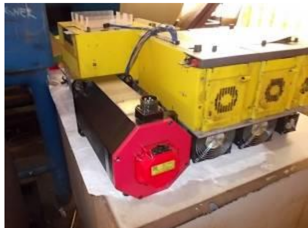
P11) Der Z-Motor. Der X-Motor hat noch eine Bremse. Es sind 7 KW Vorschubmotoren.
