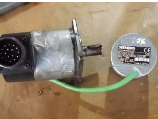
P26) Der alte Fanuc Geber (links) kommt weg. Ein neuer (rechts) wird montiert.
