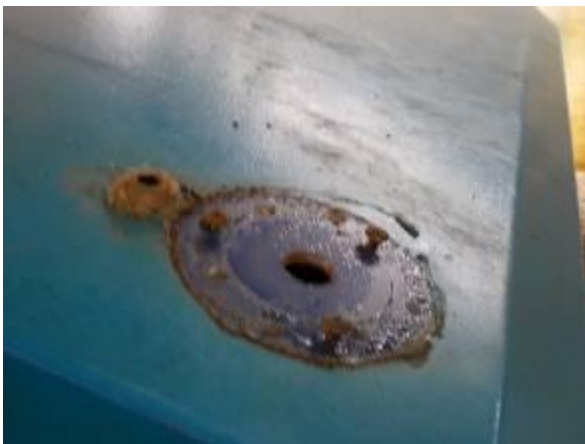
P1) Das war eine Lampe. Oben, wo die Schraube ist, war ein Loch. Das war der Grund, warum die CNC Steuerung Fanuc 18 i zerstört wurde.
