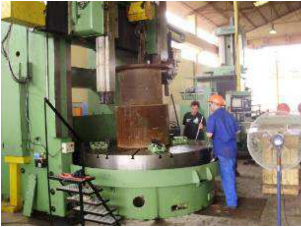
Vormals konventionelle TITAN Karussell Drehmaschine aus Europa nach Angola geliefert, umgebaut auf CNC Steuerung. WU_240_550
