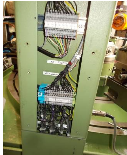
Auf der Seite der Säule mit den Klemmen für das externe Panel. So, dass beim Kabelbruch ohne löten zu müssen, das Kabel schnell ersetzt werden kann. WU5140
