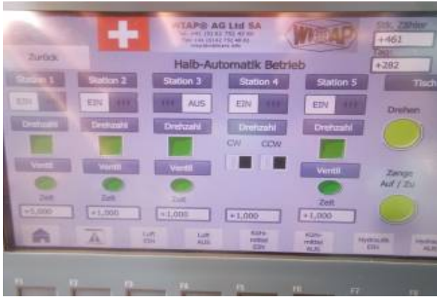
3 Grundbilder der Maschine: Hand, Halbautomat und Automat, einfach für den Operator, für eine sichere Handhabung. WU5130u
