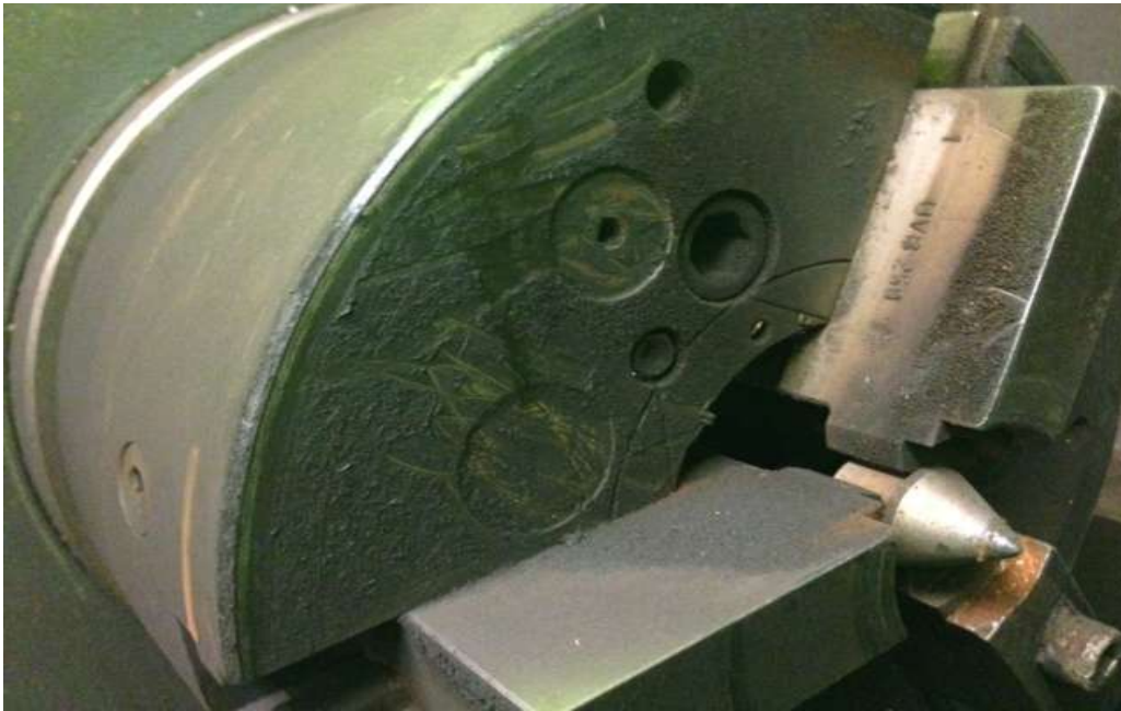
Bild 6: Wenn immer nur Probestäbe gedreht werden muss das Futter nicht zerlegt werden, wenn aber ab und zu das Futter verwendet werden sollte, wäre das unbedingt notwendig.
