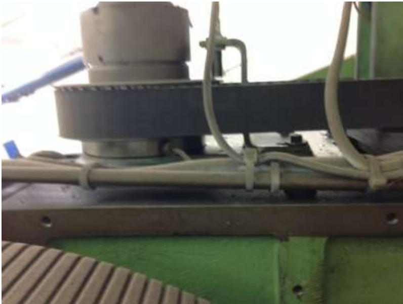
Bild 10.: Wenn die Maschine nur noch 3 Jahre laufen soll, muss den Riemen nicht ersetzt werden wenn jedoch mehr als 3 Jahre gearbeitet werden soll, wäre ein Wechsel kein Fehler.
