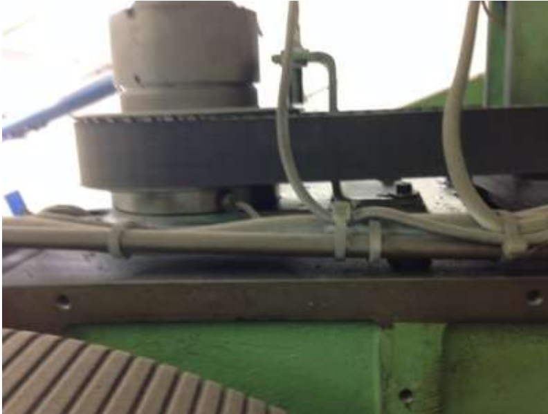
Bild 8.: Wenn die Maschine nur noch 3 Jahre laufen soll, muss den Riemen nicht ersetzt werden wen jedoch mehr als 3 Jahre gearbeitet werden soll, wäre ein Wechsel kein Fehler.
