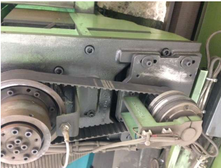
Bild 9.: Ansicht X Antrieb von oben mit Rutschkupplung dass bei Kollision nicht über 5 Tonnen Kraft aufkam. Ohne Rutschkupplung war die Kraft bei 15 Tonnen, Das hatte die Führungen im Beton nicht so gerne.
