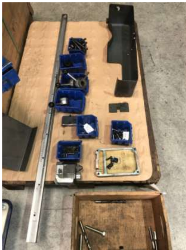
Bild 19: Alle demontierten Schrauben und Räder in Gebinde tun und jedes anschreiben und der Reihen nach hinstellen dass bei der Montagen nicht vergessen geht und nur rückwärts montiert werden kann.
