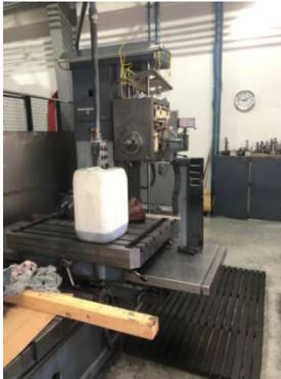
Bild 3: Als erstes soll man das Oel raus lassen unter dem Spindelstock hat wes 2 Schrauben eine links und eine in der Mitte demontiert werden für die Demontage
