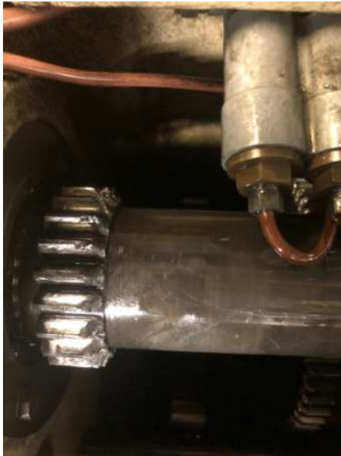
Bild 19: Es sind nicht alle Zahnräder gehärte darum sehen diese auch nicht so schön aus.
