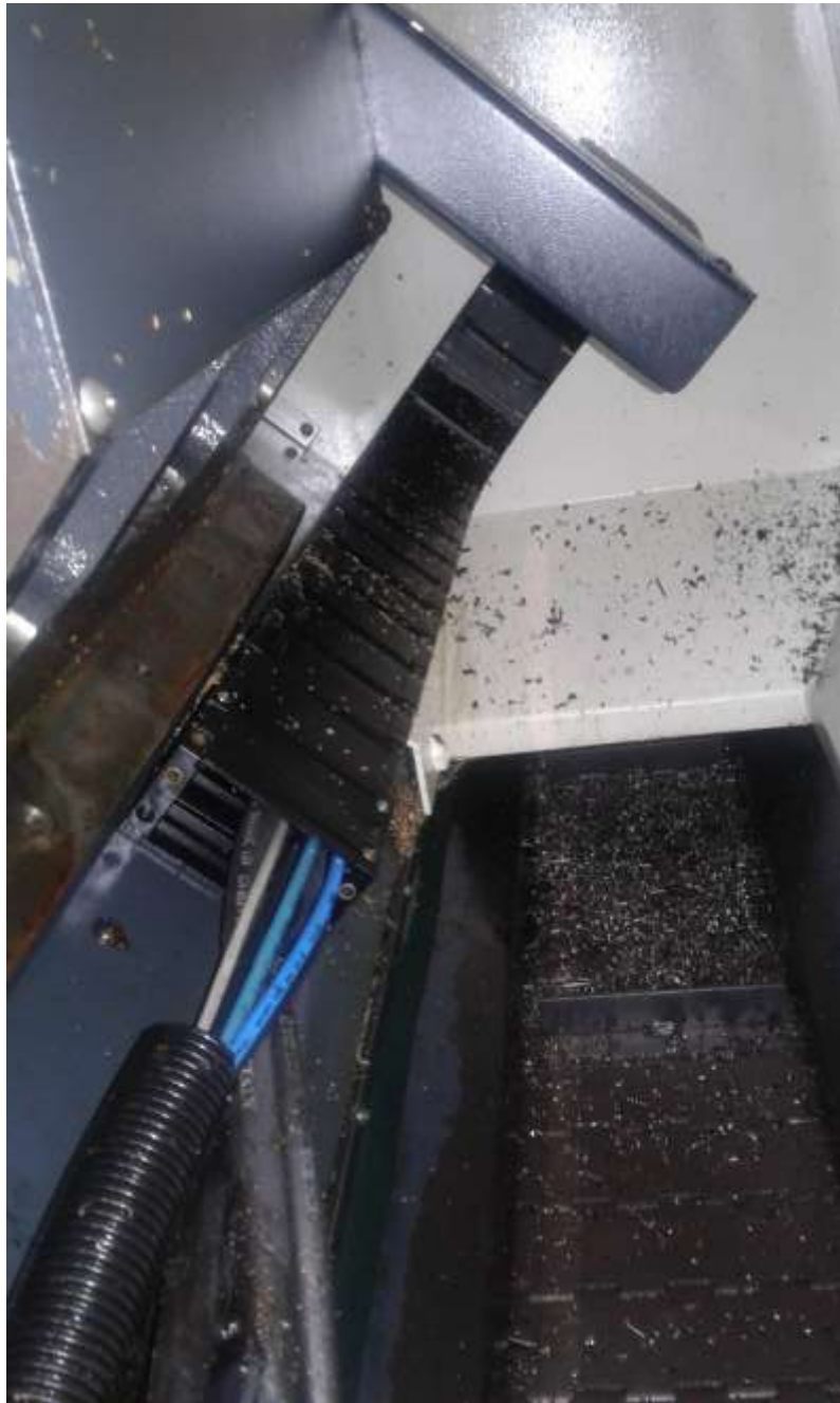
Bild 11. Schlauch vom Reitstock in den Kabelschlepp. Sind diese Kunststoffe Schläuche und Kabelschlepp heudet auch gegen Späne stark genug? Eigentlich sehen diese noch gut aus für das Alter der Maschine
