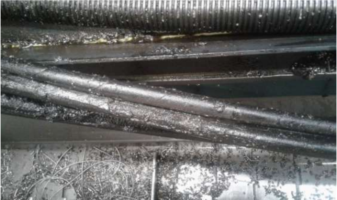
Bild 7: Die Späne und die Emulsion haben die Schläuche angegriffen
