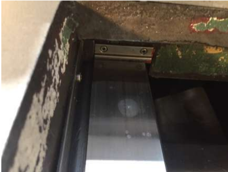
Bild 8: In der Regel sind die Z und Reitsock Führungen bei Flachbett Maschinen immer getrennt
