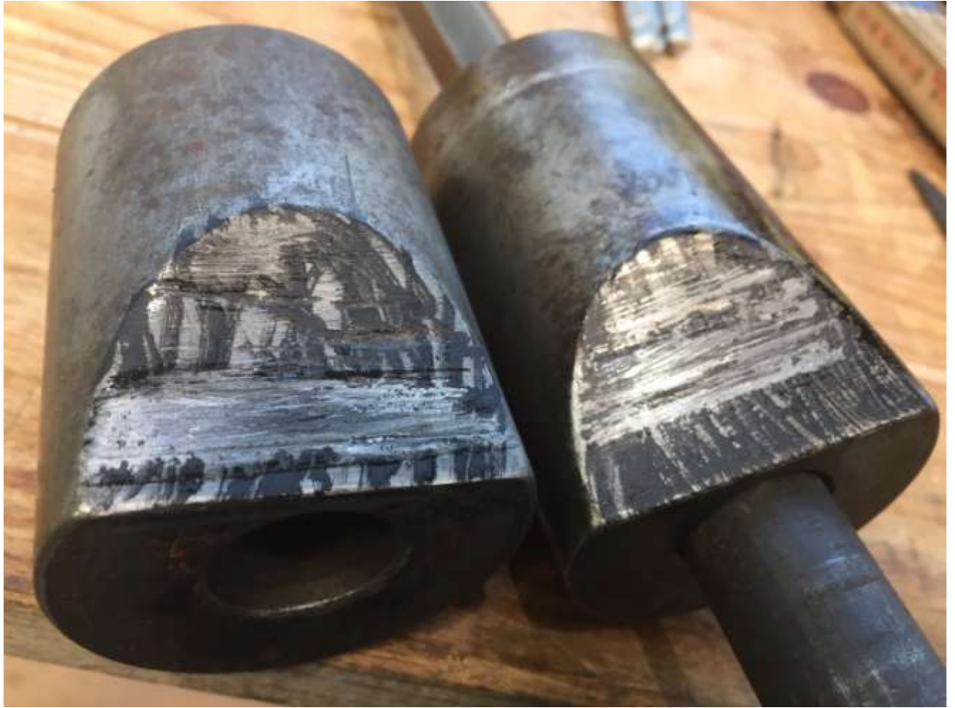
Bild 11. Die Reitsock Pinole hat angefrassen bei der Klemmung. Die Zapfne sidn aus Grauguss sollte nich passieren.
