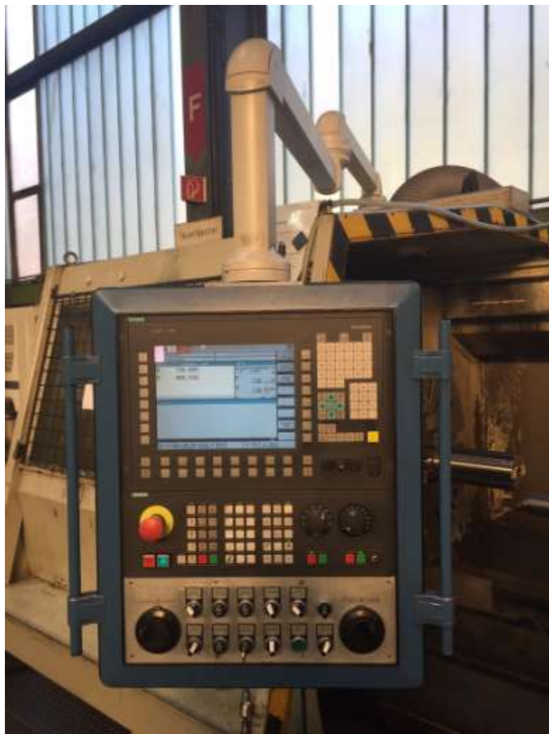
TITELBILD1: Umgebaute CNC Drehmaschine mit Sinumerik 840
