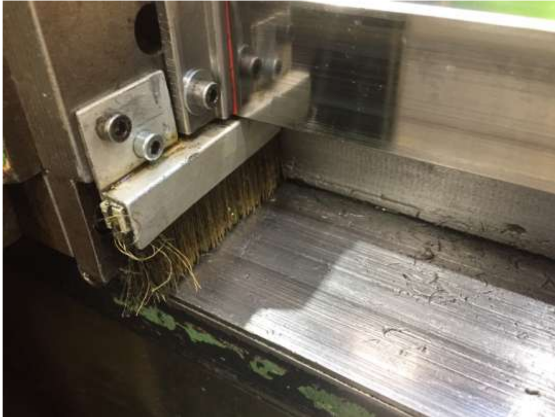
Bild 9; Zusätzlich zu den Abstreifern, Bürsten helfen die Lebensdauer zu verlängern der Abstreifer
