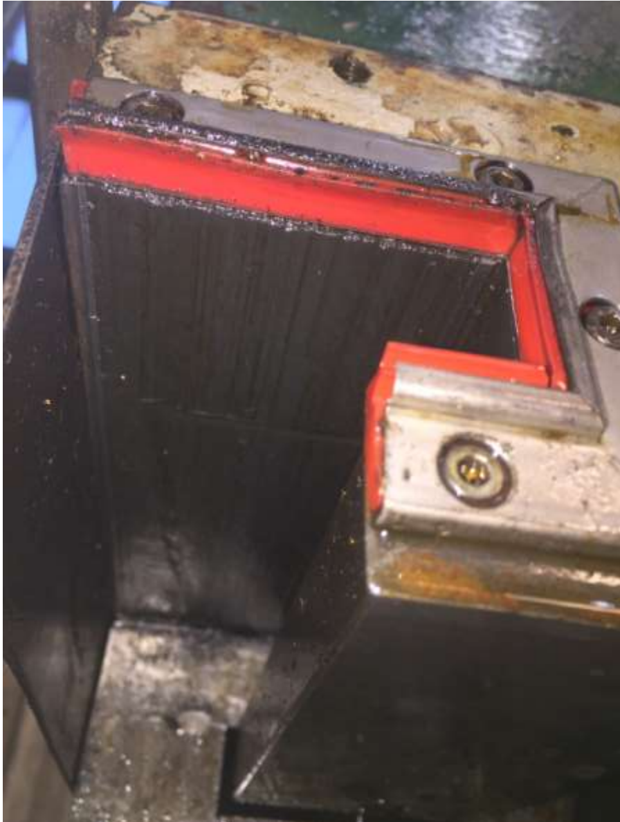
Bild 5. Weipert wählte hier ein eigener Weg bei der Führungsgestaltung sie fährt mit einem Langen X Schlitten mit dem Oberschlitten über die die Führungen hinaus. Das forderte an den Operateur drauf zu achten, dass die Führungen gelegentlich gereinigt und geprüft werden.
