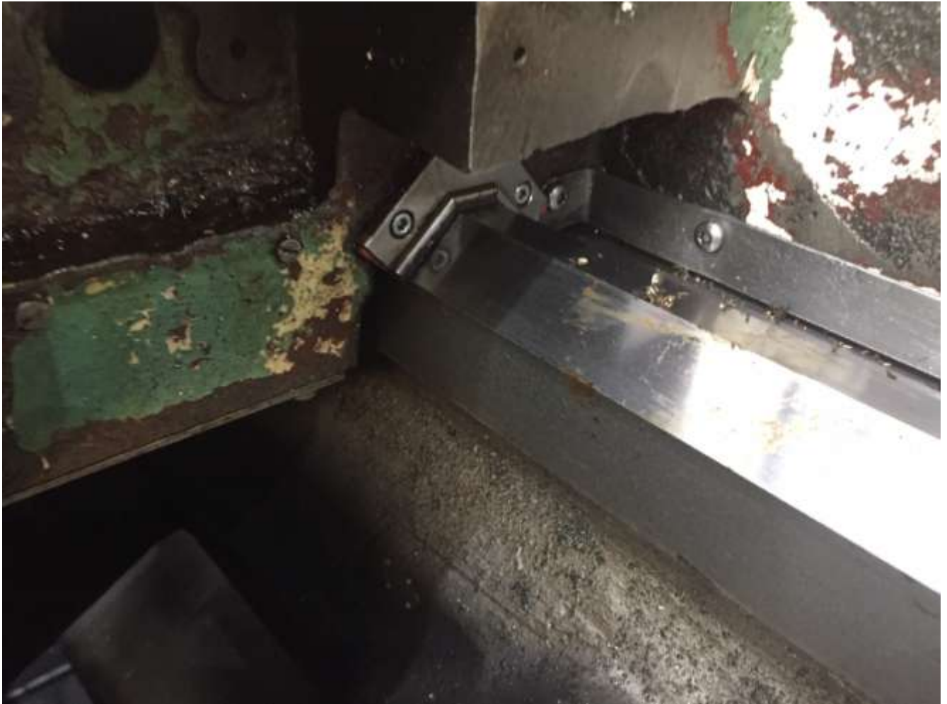
Bild 7. Sehr wichtig die Abstreifer immer gut pflegen, dass nie Schmutz unter die Gelitbeläge kommt.
