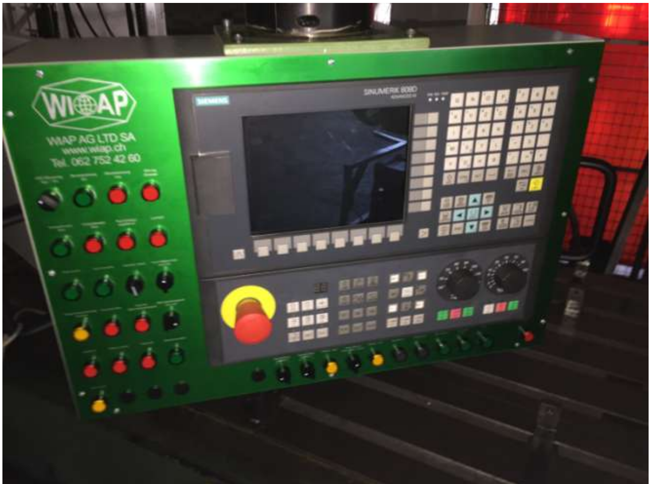
Titelbild 1: Waldrich Hobelmaschine umgebaut von WIAP mit Sinumerik 808
