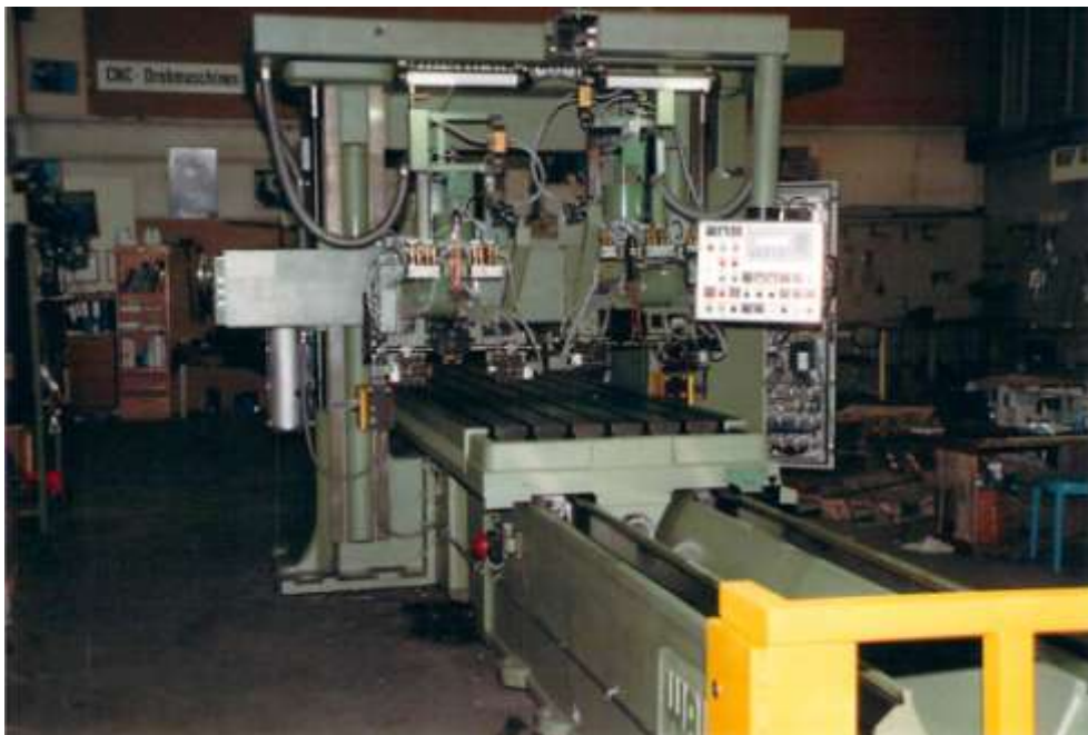
Bild 3: 2 Schlitten links und 2 Schlitten rechts 8 Werkzeuge gleichzeitig im Einsatz mit Link / Rechtsspindeln war die Maschine schneller als schnell. Keine Fräsmaschine hatte nur den Hauch eine Chance gegen diese Geschwindigkeit und die Verzugsfreiheit, was ja das Hobeln in sich hat, heran zu kommen
