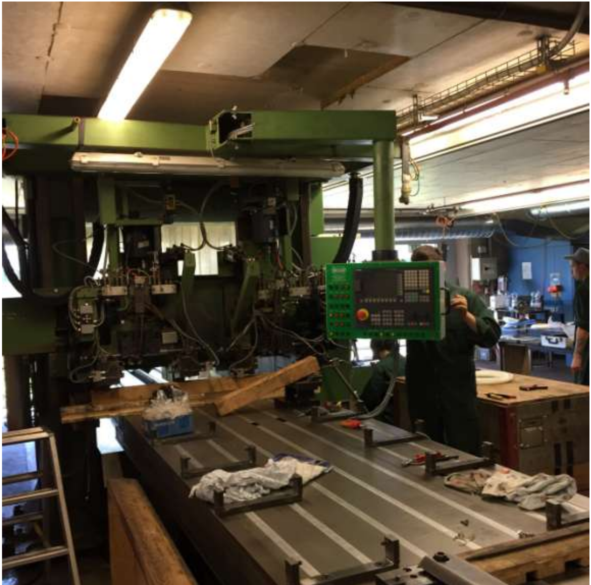
Bild 8: Fertig umgebaute WIAP CNC Hobelmaschine Waldrich Coburg. Service und Reparaturen und die Betreuung der Maschine macht die WIAP nach einem Umbau aber auch ohne Umbau auch
