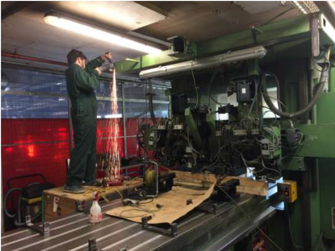
Bild 6: Der zweite Umbau nach 20 Jahren Produktion. Wie so oft die Ersatzteil Gewährleistung für die Elektronik. Sven Widmer macht Anpassungen
