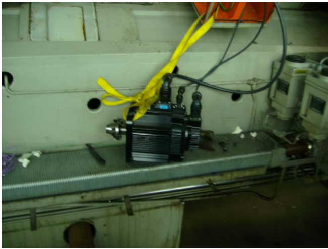
Bild 10: Für die ersten Testläufe hat man den X-Vorschubmotor noch nicht montiert, um alles vorher einstellen zu können.
