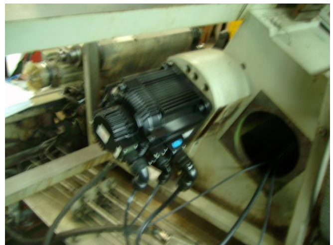
Bild 8: Der neuen 20 Nm Z-Vorschub Antrieb wird direkt aufgesetzt, ohne Untersetzung.
