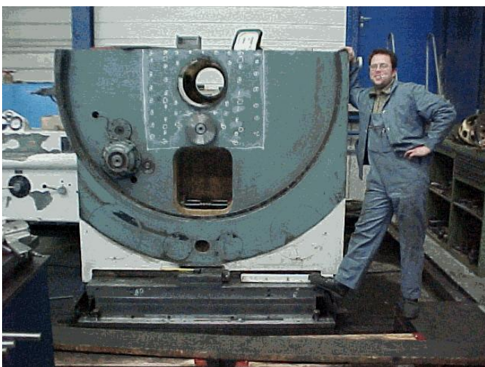
Bild 4: Hier haben wir angezeichnet, wie wir eine neue Frontplatte befestigen. Der Spindelstock hatte einen Riss quer gespalten. Mit der grossen Frontplatte haben wir das weitere Spreizen verhindert. Auf einem Bohrwerk musste alles sauber gefräst werden und viele grosse Gewinde waren nötig, damit die Anpresskraft mit der Reibung übereinstimmt, um weiterhin grosse Werkstücke beladen zu können.
