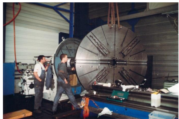
Bild 2: Es braucht eine feinfühilige Handhabung mit dem Kran, wenn so eine Planscheibe von der Spindelnase entfernt werden muss.
