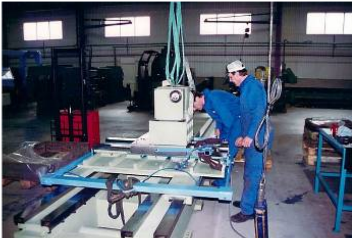
Bild 12: Einschaben der Schlitten X und Z Achse
