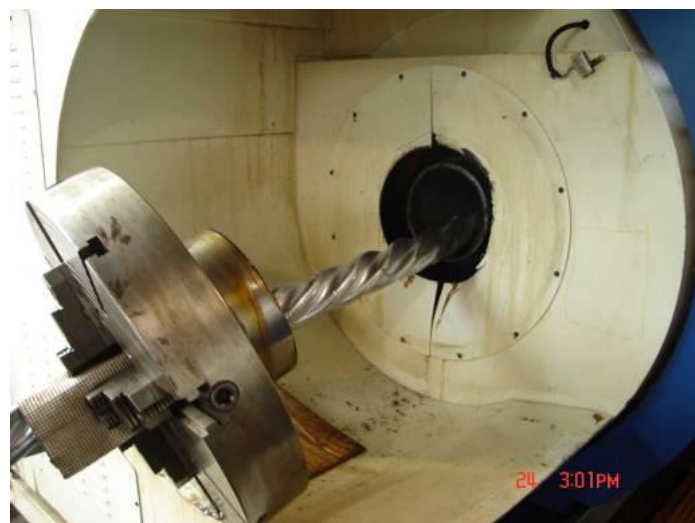
Bild 3: Die gerissene Spindel. Ein Schaden über USD 100'000.- Bitte siehe den neuen Bericht, der die Revision beschreibt. Danke.
