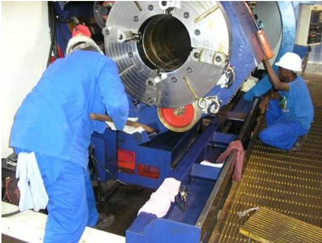
Bild 4: Der neue Spindelstock wurde mit einer grösseren Bohrung bestellt. Die herkömmliche Bohrung war nur 250 mm; die neue 320 mm.
