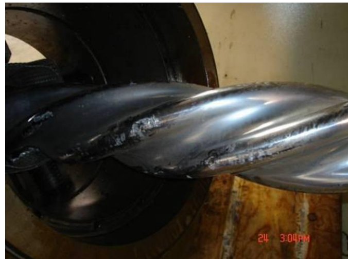
Bild 2: Die defekte Spindel.
