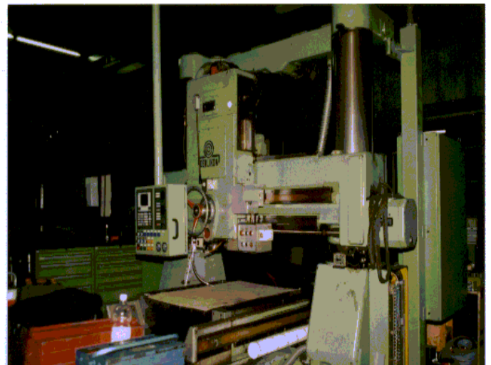
Bild 2: Maschine nach dem Umbau mit der neuen Sinumerik CNC Steuerung
