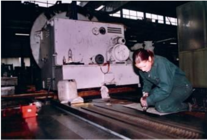
Bild 8: Mit der Schabmaschine kann ca. 5 x schneller geschabt werden, als mit dem einfachen Handschaber. Ist viel Erfahrung vorhanden, ist es bis ca. 20 x schneller.
