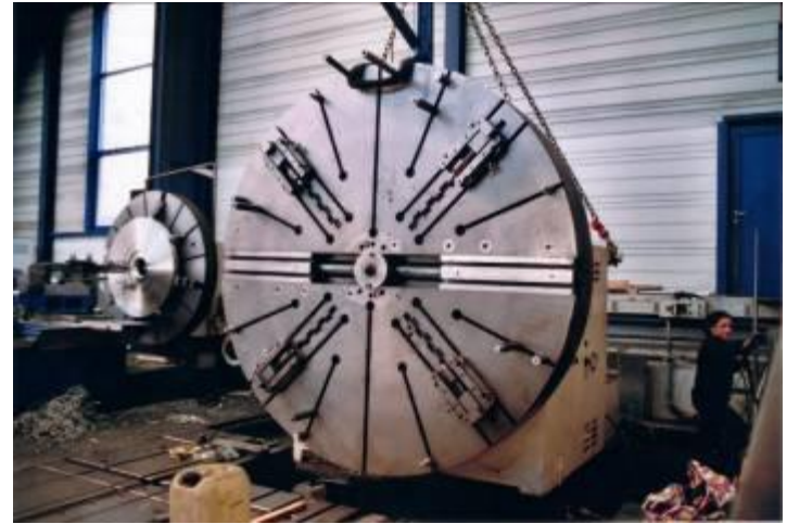
Bild 10: So ein schwerer Spindelstock für jede Messung neu aufsetzen, ist mühsam, d.h. es lohnt sich, genau zu wissen, wieviel Hundertstel wo entfernt werden, durch Schaben. Dank der grossen Erfahrung durch viele Umbauten und die intensive Ausbildung bei einem Drehmaschinen Hersteller konnten alle Mitarbeiter viel lernen und können heute auch ihre Erfahrung weiter verwenden, um eine gute Arbeit auszuführen.
