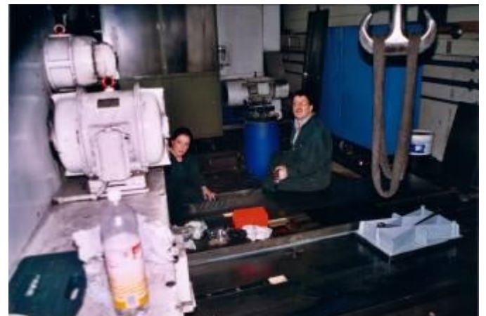
Bild 7: Der ganze Schabprozess wurde etwas aufgeteilt, weil es sehr grossen Flächen zum schaben waren.
