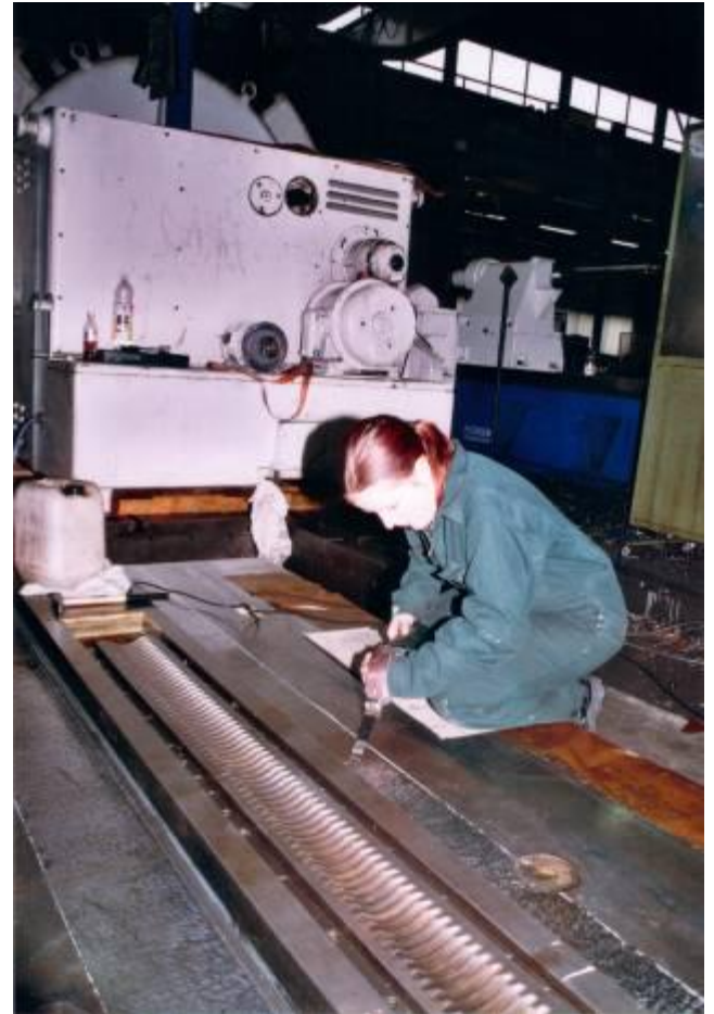
Bild 6: Jetzt wurde der Fehler mit der Schabmaschine korrigiert. In der Regel werden pro Schabdurchgang, je nach Druck, ca. 0.002 bis 0.005 mm entfernt. D.h. wenn ein Fehler im 0.1 mm Bereich ist, muss doch einiges geschabt werden.
