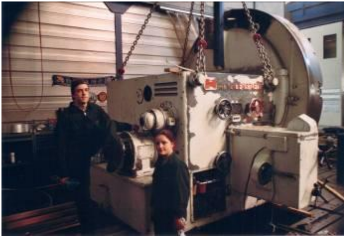
Bild 5: Es geht besser mit den Ketten den Spindelstock gerade zu hängen, als mit Seilen. Ein Hersteller macht in der Regel ein Hängejoch, welches den Spindelstock genau gerade hängen lässt. Das ist jedoch schwieriger bei sporadischen Reparaturarbeiten.
