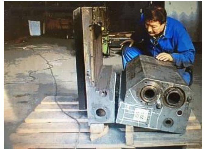
Bild 6: Die Walzendrehmaschine MFD war schwer. Hier konnte der Vorschub Getriebe Kasten, der am Längsschlitten befestigt war, abgetrennt werden. Der wurde nicht mehr benötigt.
