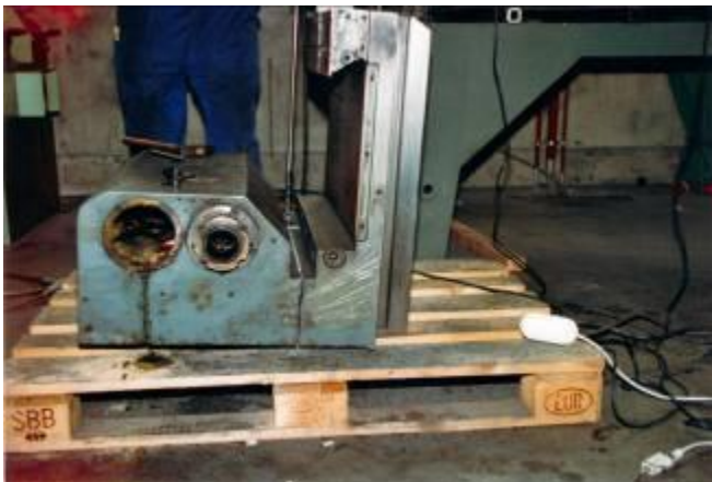
Bild 5: Bald war die Bohrarbeit, welche mit einer guten Magnetbohrmaschine geht, erledigt.
