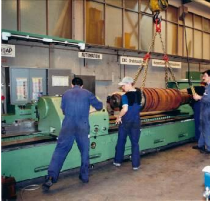
Bild 11: Die Maschine beim Walzen Testdrehen. Die Z Kugelrollspindel mit 80x10. Abgedeckt dank dem Wiap Kugelrollspindel Abdecksystem.
