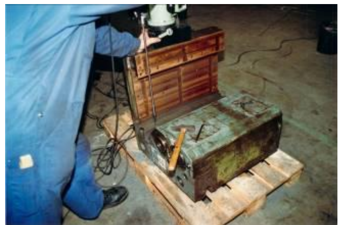
Bild 3: Viele Bohrungen, die direkt nebeneinander gebohrt wurden, dass am Schluss nur mit einem Schlag alles getrennt werden konnte. Bei Grauguss geht das sehr gut.
