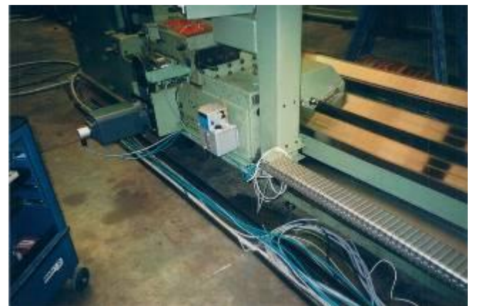
Bild 7: Die Bettbahnführung, Einlagebänder wurden ersetzt. Der Längsschlitten neu mit Kabelschlepp gemacht. Das ganze Vorschub System neu konstruiert und erneuert.
