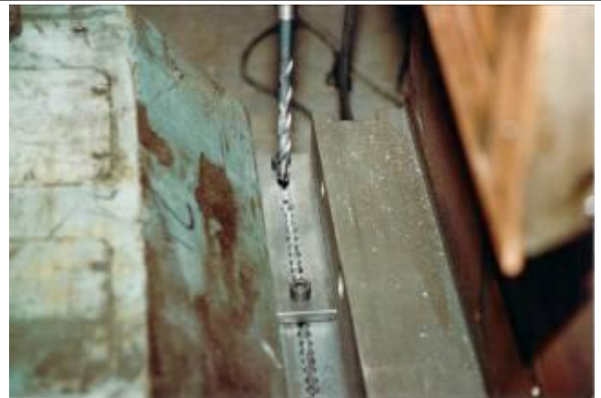
Bild 2: In Russland, wenn kein Bohrwerk vorhanden war, wurden auch Elemente abgetrennt. Es ist etwas, das ein Maschinenschlosser noch lernen musste.
