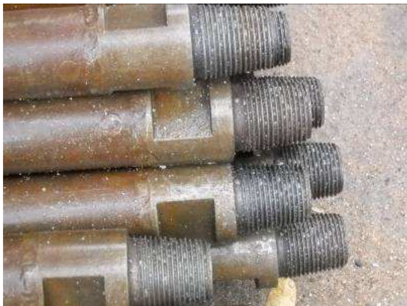
Photo: das sind Bohrgestänge
