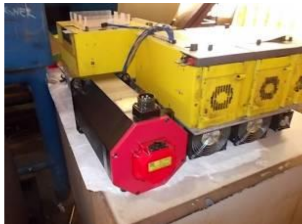
P11) A Z-motora. O motor X tem um freio. Há 7 motores de alimentação KW.
