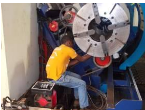
P13) Yoba no desenvolvimento do motor principal. Ele tirou a correia trapezoidal.
