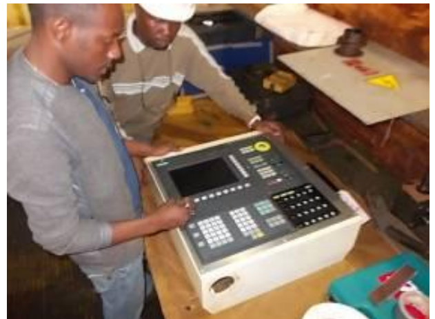
P16) Yoba baut die Sinumerik 802 ein. Das Blech vorne wurde aus rostfreiem Stahl gemacht. Die Jungen merken, dass Gewindeschneiden bei rostfreiem Stahl hartnäckig ist.
