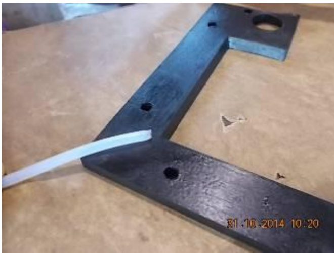
P42) Zusätzliche Schmierstellen für die Z-Achse. Normal macht ein guter Maschinenbauer bei Kurzhub Maschinen mehr Schmierstellen in der Verfahrachse. Mega Bore machte nur eine in der Z Achse. Wenn nun immer Gewinde geschnitten wird mit einem Verfahrhub von weniger als 200 mm, wird der lange Schlitten mit nur einer Schmierstelle, ungenügend geschmiert. Wir machten jetzt 3 Schmierstellen pro Führungsbahn. Ideal wäre für den langen Schlitten 5 Schmierstellen. Dch dann hätten wir den Schlitten demontieren müssen.
