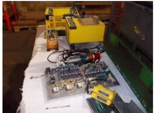
P10) Ausgebautes Steuerungsmaterial der Fanuc 18i.
