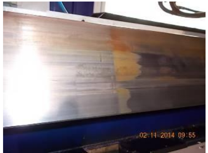
P39) Die Maschine hat eine fehlerhafte Schmierung. Erst als Oel kam, kam der braune Gleitbelag Abrieb zum Vorschein.
