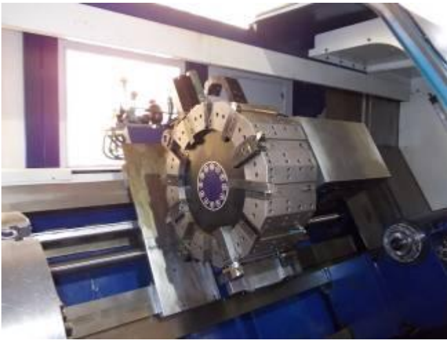
P31) Ein Foto des Werkzeugrevolvers der Maschine, ohne Abdeckung. Es ist ein Italiener Revolver Baruffaldi.
