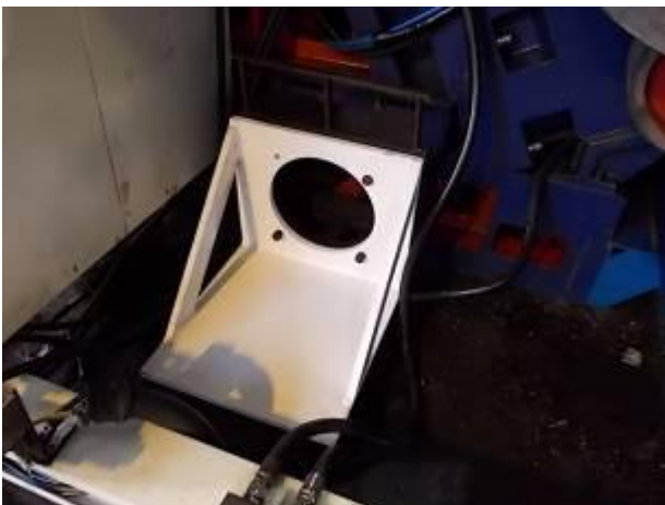
P14) Da der neue Motor ein Fussmotor ist, mussten wir ein Stehlochrahmen machen. Wir montieren an allen Maschinen denselben Motor. Dadurch ist die Ersatzteihaltung einfacher.
