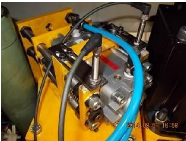
P37) Robuste, eigenentwickelte Bremskonstruktion. Mit Schalter gebremst und ungebremst. So eingestellt, dass auch ein Druck unter 3 Bar erkannt wird.
