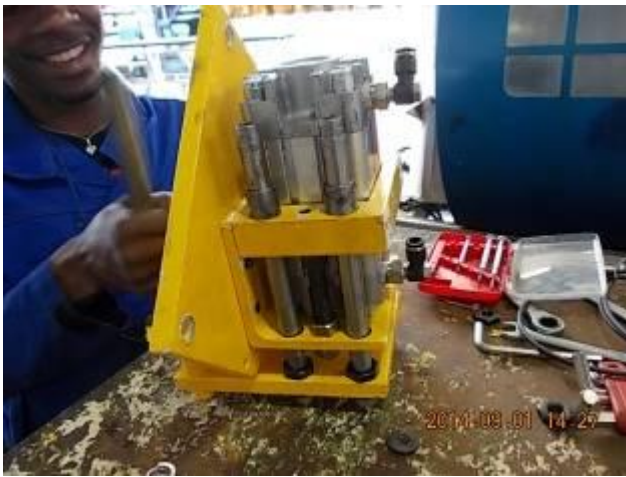
P36) Bremszylinder. Der Zylinder wird als Norm verwendet.
