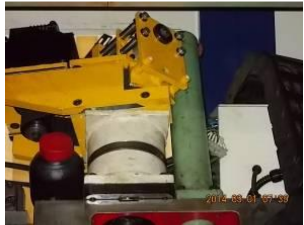
P34) Der X-Motor mit der neuen Bremse. Die Bremse wurde gemacht, damit alle dieselben Vorschubmotoren verwendet werden können.
