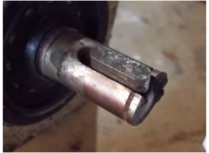
P27) Der Fanuc Geber hat viel Passrost, weil dieser ohne Achsfluchtfehler Kupplung montiert wurde. So wie wir es bei den Gebern machen, die wir bei den Siemens CNC einbauen.
