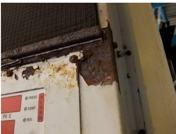
P2) Durch das extrem harte Klima in Angola, sehen die billig hergestellten Geräte in 2 Jahren so aus.
