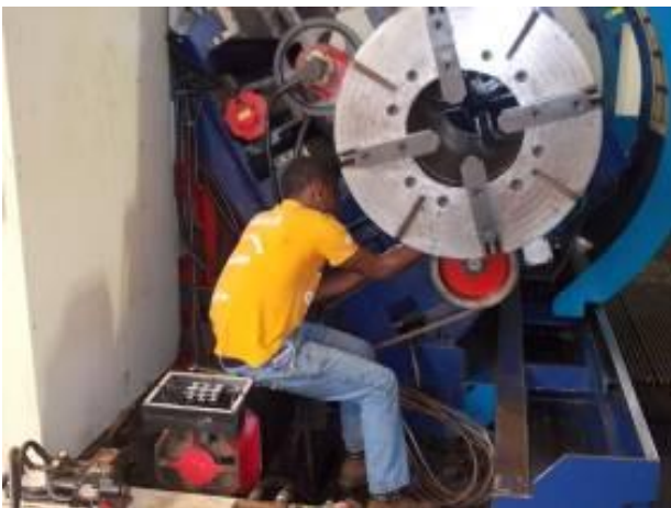
P13) Yoba beim Ausbau des Hauptmotors. Er entfernt die V- Riemen.
