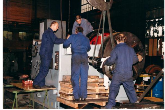
P6: Các headstock cũng được sửa đổi, đã có một số bánh răng khiếm khuyết. Messrs. Walter Grell thực hiện vào thời điểm đó các bánh răng theo mẫu.
