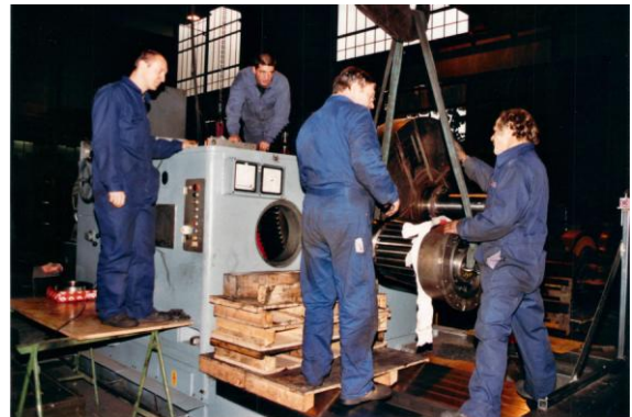
P7: шестерні і вали табору були в Maschie все оснащені розбирання SKF Press Association і повторної збірки зажадав деяких зусиль.
