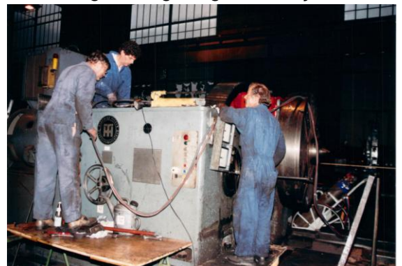
P7: as engrenagens e eixos campos estavam no Maschie todos equipados com a desmontagem SKF Press Association e re-montagem exigiu algum esforço.
