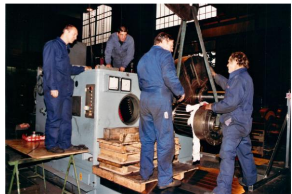
P7: as engrenagens e eixos campos estavam no Maschie todos equipados com a desmontagem SKF Press Association e re-montagem exigiu algum esforço.
