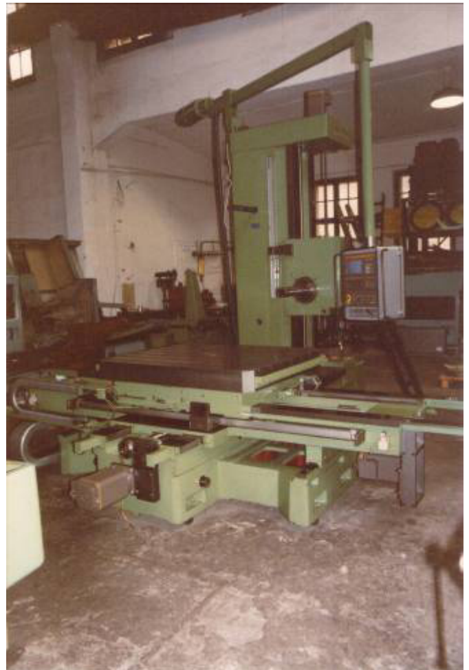
3 lineare Achsen X ,Y und Z und der Rundtisch. Zudem noch eine lineare W Achse in der Ergänzung zur Z Achse. WU5010
