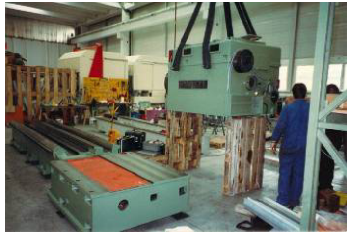
Diese robuste, schwere, konventionelle Walzendrehmaschine wird von der WIAP auf CNC umgebaut. WU4725
