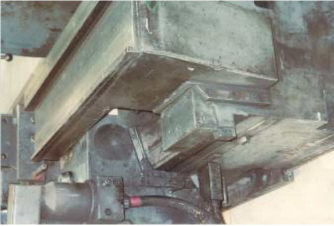
Die Unterschlitten Konstruktion musste für die Kugelrollspindeln in der X-Achse und Z-Achse umkonstruiert werden. 80 x 10 mm. WU4765
