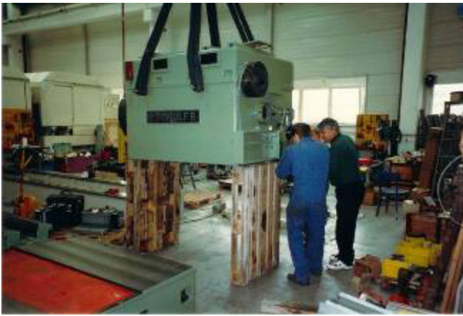
Auch der Spindelstock musste neu eingeschabt und ausgerichtet werden. Zylindrizität von weniger als 0.02 mm auf 500 mm. WU4710
