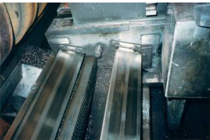
Die Z-Achsführung ist für einen sehr starken Querschachtschnittdruck ausgelegt. Die Maschine
