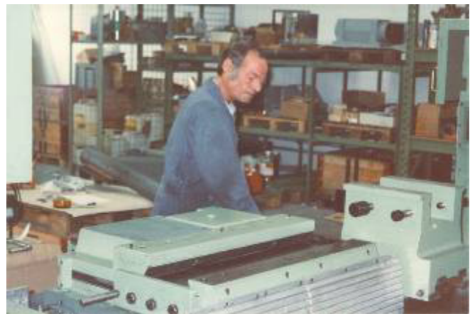
Wir haben das ganze Schlittensystem nachgebessert. Schmierbohrungen ergänzt. Alles neu geschliffen und neu eingeschabt. Auf 10 Auflagepunkte pro mm/2 Zoll geachtet. WU4730
