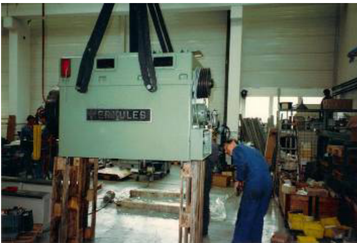
Den schweren Spindelstock unten zu schaben, war nicht so einfach. Wegen dem Gewicht war er zum Umdrehen nicht gut geeignet. Also war das Überkopf Schaben nötig. Wäre der Fehler gross gewesen, hätten wir ein Umdrehjoch gemacht, um den Spindelstock einfach wenden zu können. WU4705
