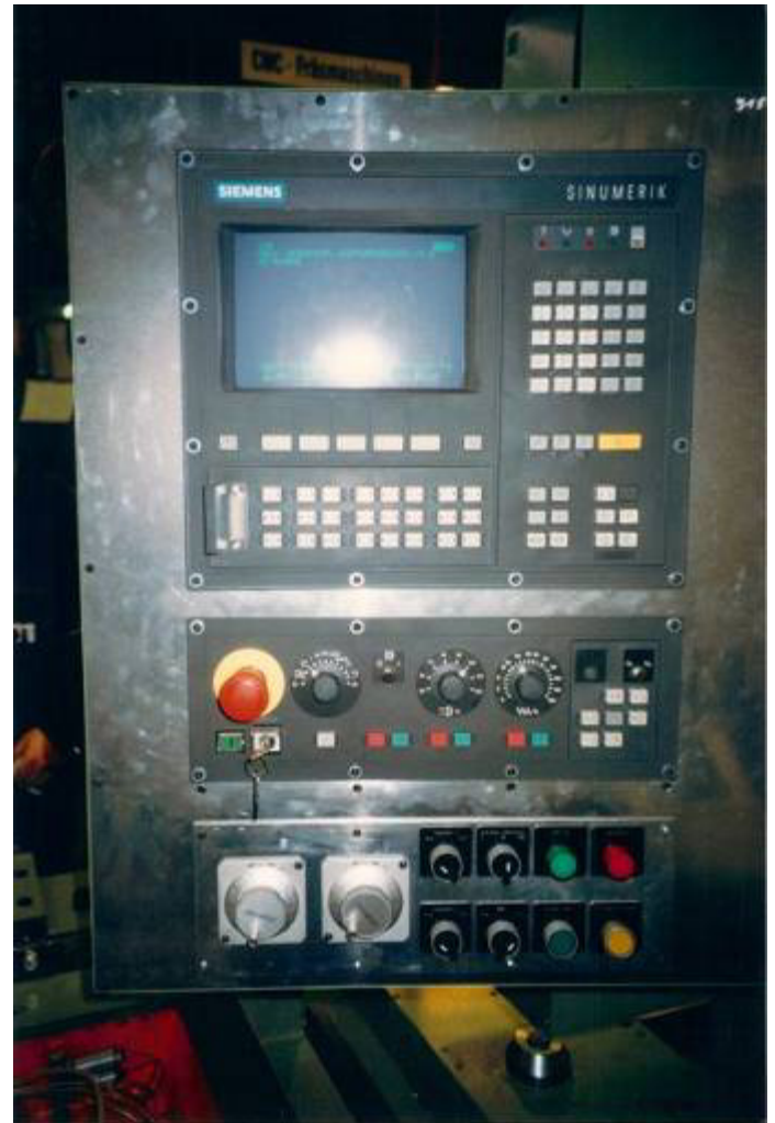
Die CNC Steuerung Sinumerik 810T war für die Operateure leicht bedienbar gemacht. Fast keine Schalter waren nötig, um mit der Maschine arbeiten zu können. WU4605
