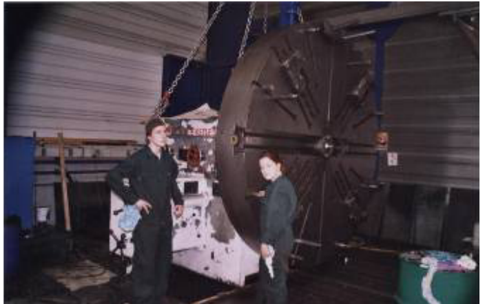
Demontage des schweren Heyligenstaedt Spindelstockes. Es benötigte besonders grosses Werkzeug für das Lösen des Spindelstockes. WU3240
