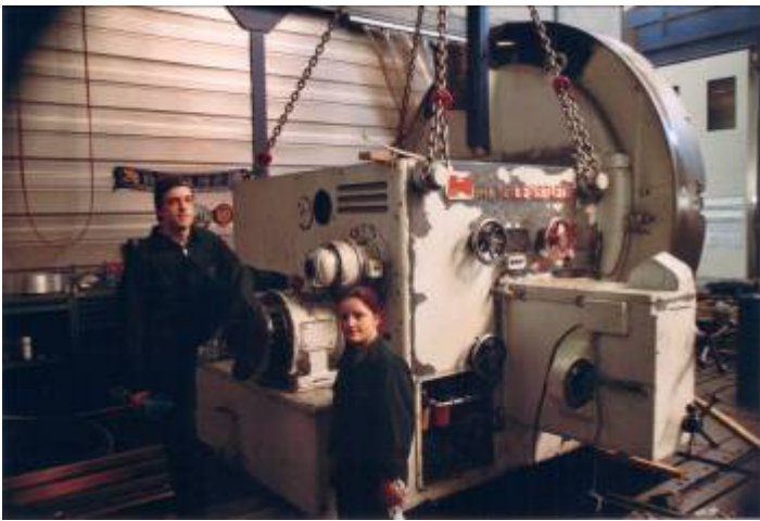
Es geht besser mit den Ketten den Spindelstock gerade zu hängen, als mit Seilen. Ein Hersteller macht in der Regel ein Hängejoch, welches den Spindelstock genau gerade hängen lässt. Das ist jedoch schwieriger bei sporadischen Reparaturarbeiten. WU3230
