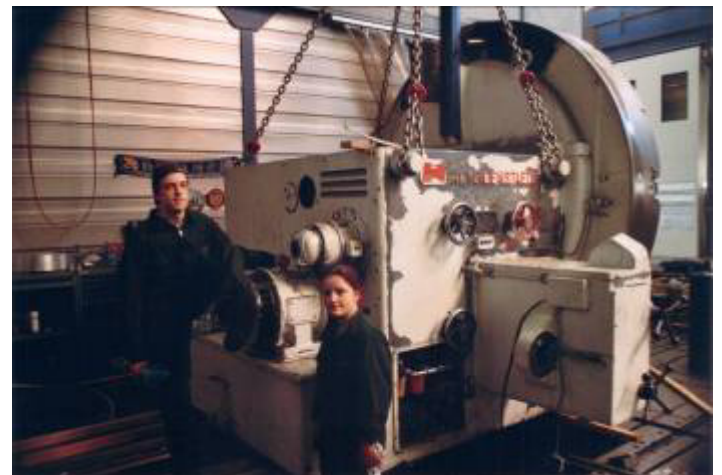
Der Spindelstock wurde mit Ketten angehoben. WU3250
