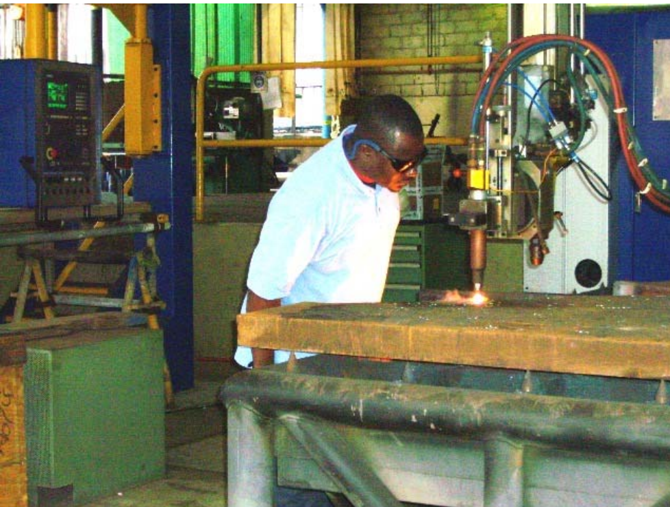
Photo: Hier bereitet man ein Schnitt vor durch eine über 100 mm dicke Stahlplatte. Diese Maschine stand vor vielen Jahren mal in der Schweiz, wo sie für Afrika vorbereitet wurde.
