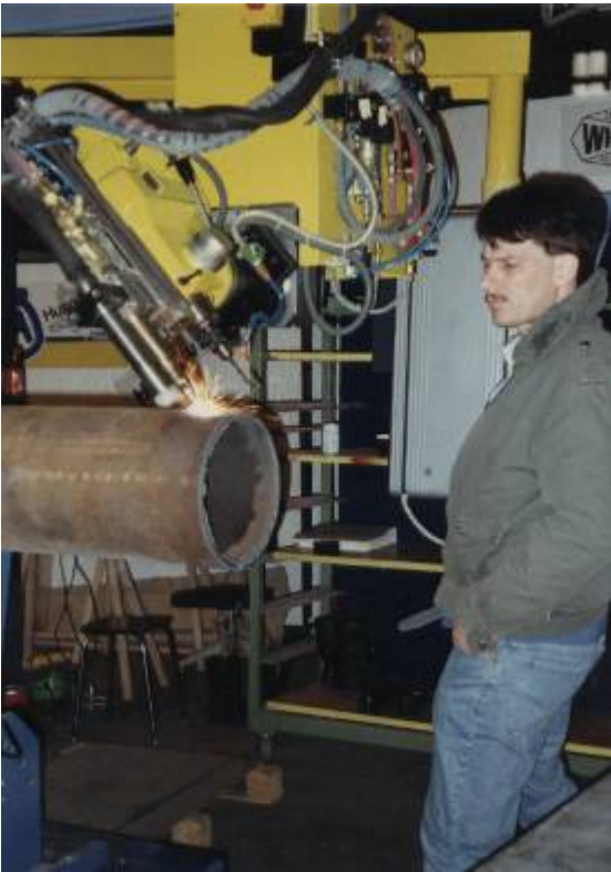
Photo 1993 Aarau: H.P Widmer, Brennschneid Maschine damals ausgelegt für Plasma und Acetylen Anlage.
