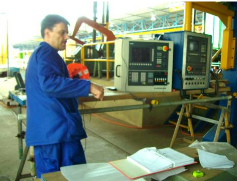
Photo: Juni 2006 Angola: 15 Jahre später wieder HP Widmer ein paar Jahre älter, wie die Maschinen. Die alten Sinumerik sind am Ende. Die Steuerungen werden verfressen vom Schwefel der Luft sowie der hohen Luftfeuchtigkeit welche oft bis 110% ist. Aber die Mechanik macht noch mit!
