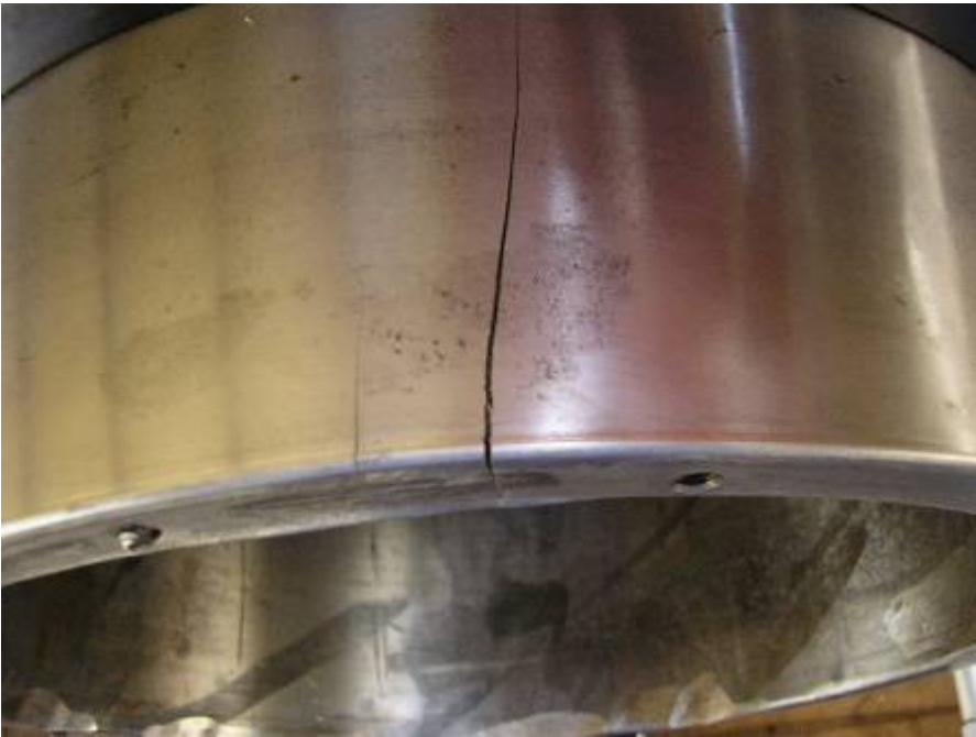
Photo: Die gerissene Spindel
