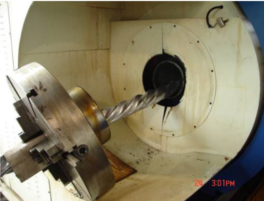
Photo: Hier das rausgerissene Handspannfutter
