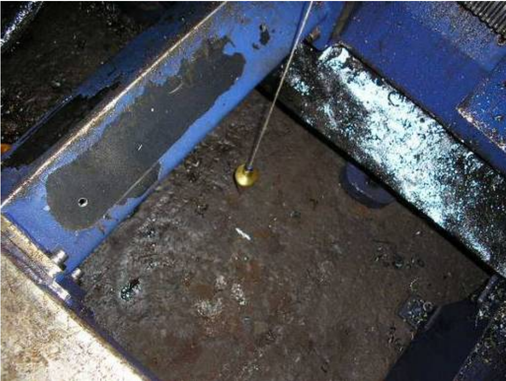
Photo20: Im Maschinenraum mussten wir den Späneförderer raus ziehen, dann machten wir hier die Markierung am Boden und man sah dass durch den Unfall die Maschine viele mm verschoben wurde.
