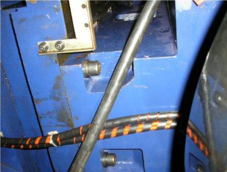
Photo27: Spindelstock Schrauben für die Feststellung hinten. Müssen wenn er gerichtet ist alle sehr fest angezogen werden. Drehmoment:
