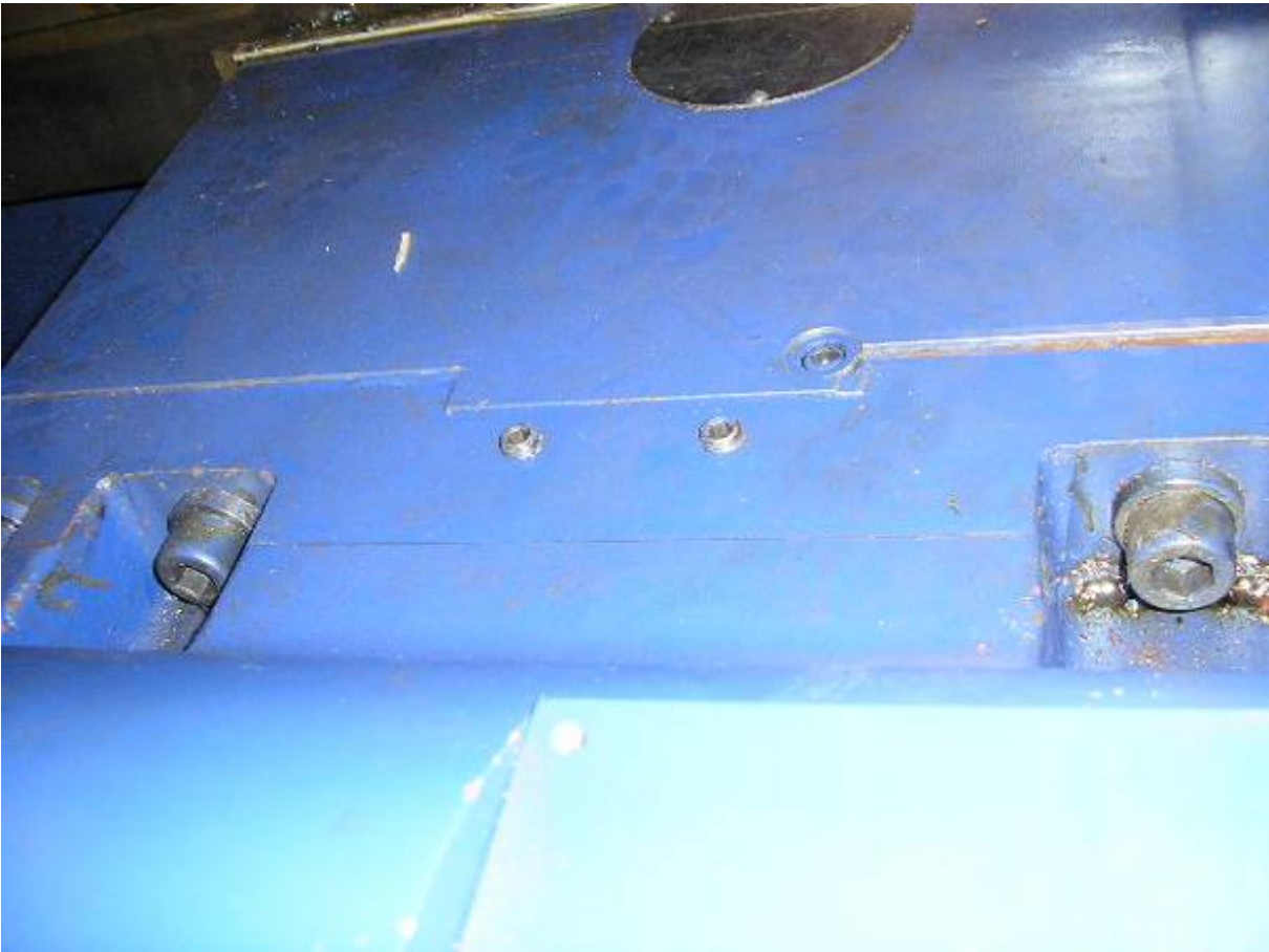
Photo31: Druck Schraube nach unten Zugschrauben nach oben ( geht nur wenn Schrauben los )
