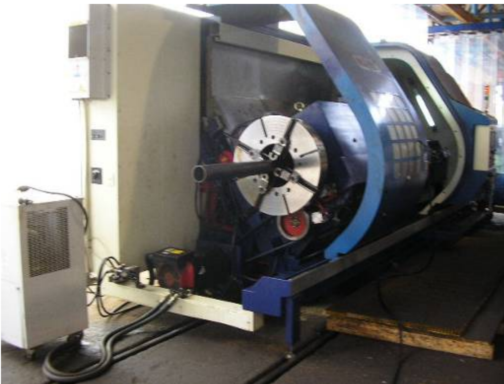
Photo34: Maschine bereit für den Anbau der neuen Verschalung,
