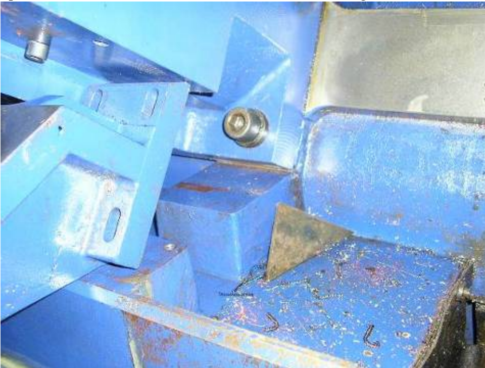
Photo26: Hier sind die Schrauben die für die Feststellung des Spindelstockes sind.
