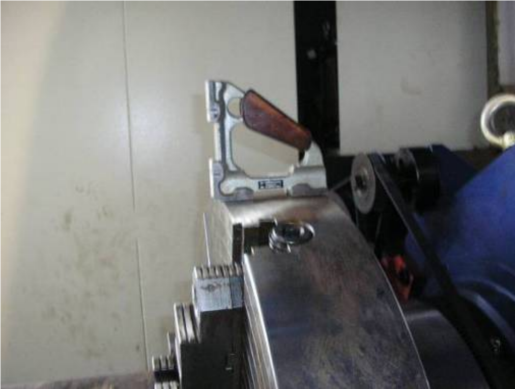
Photo22: Dann wird die Maschine auf die Maschinen Füße gestellt und neu nivelliert.
