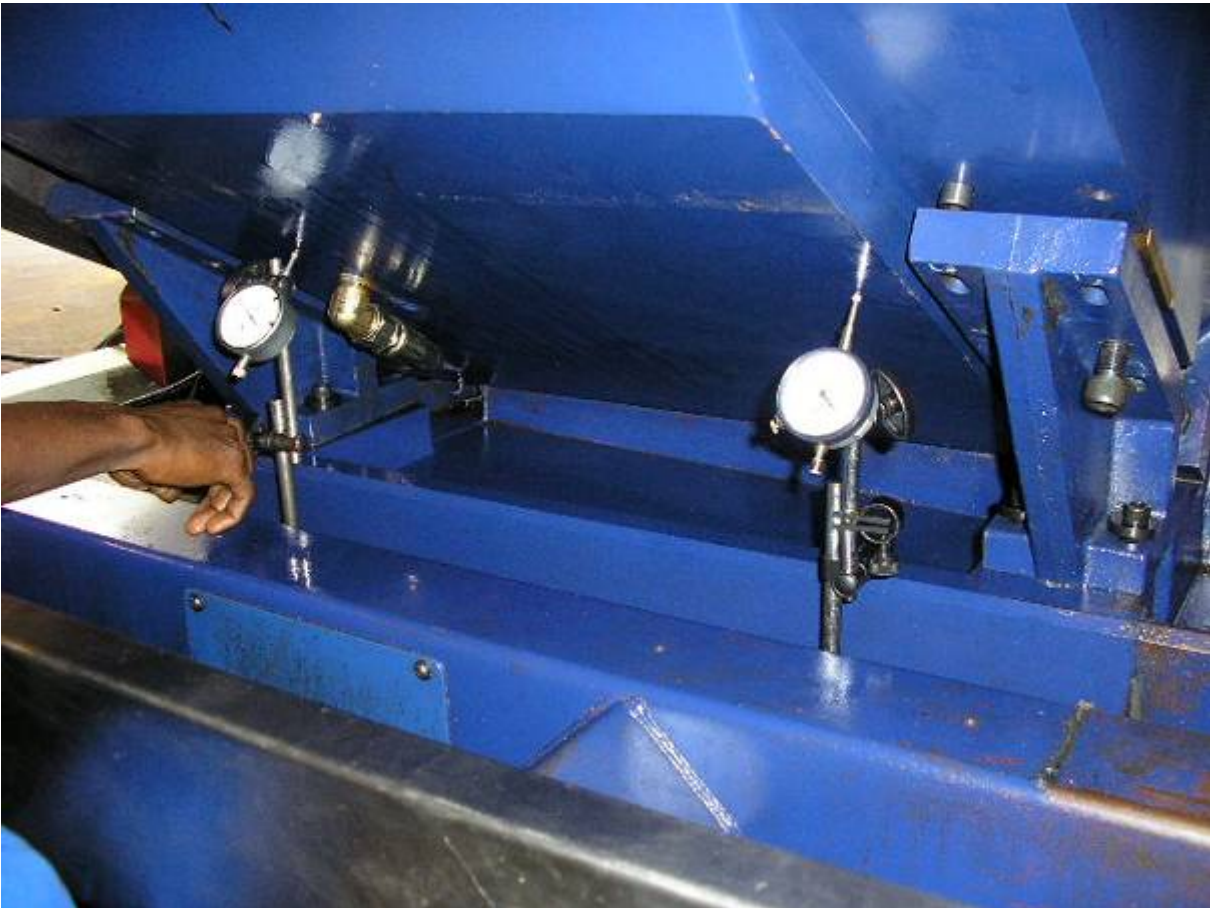
Photo25: Messuhr links und rechts unter dem Spindelstock. Mit den Regulierschrauben welche wir selber montierten kann man den Spindelstock genau ausrichten.
