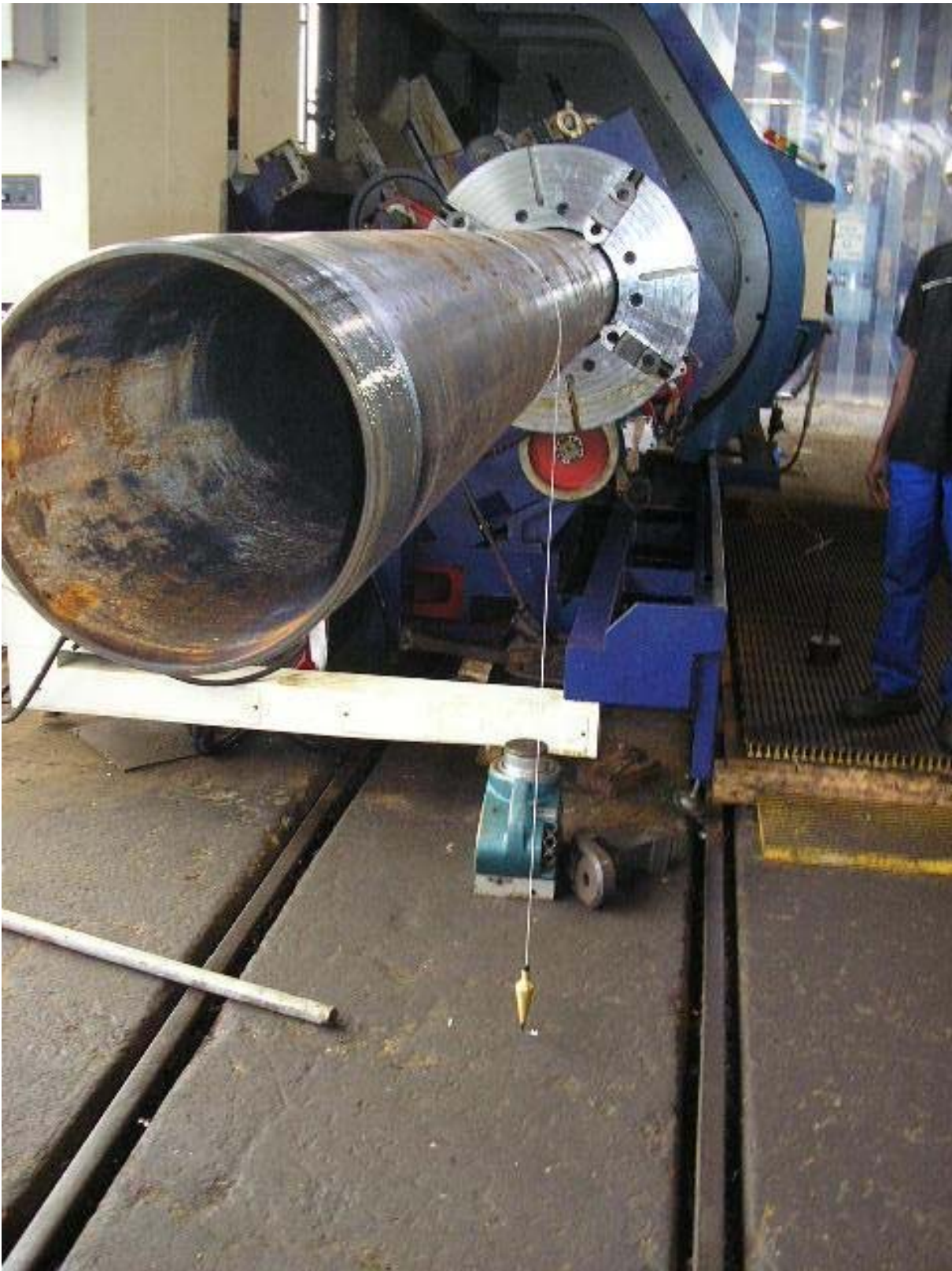
Photo19 : Wir haben dann an den Eisenbahnschienen die Mitte gemessen innen, dann die Hälfte des Rohres das oben im Futter eingespannt ist des 14 Zoll Rohres abgezogen und eine Markierung gemacht am Boden als Referenz. Für die Maschine hinten
