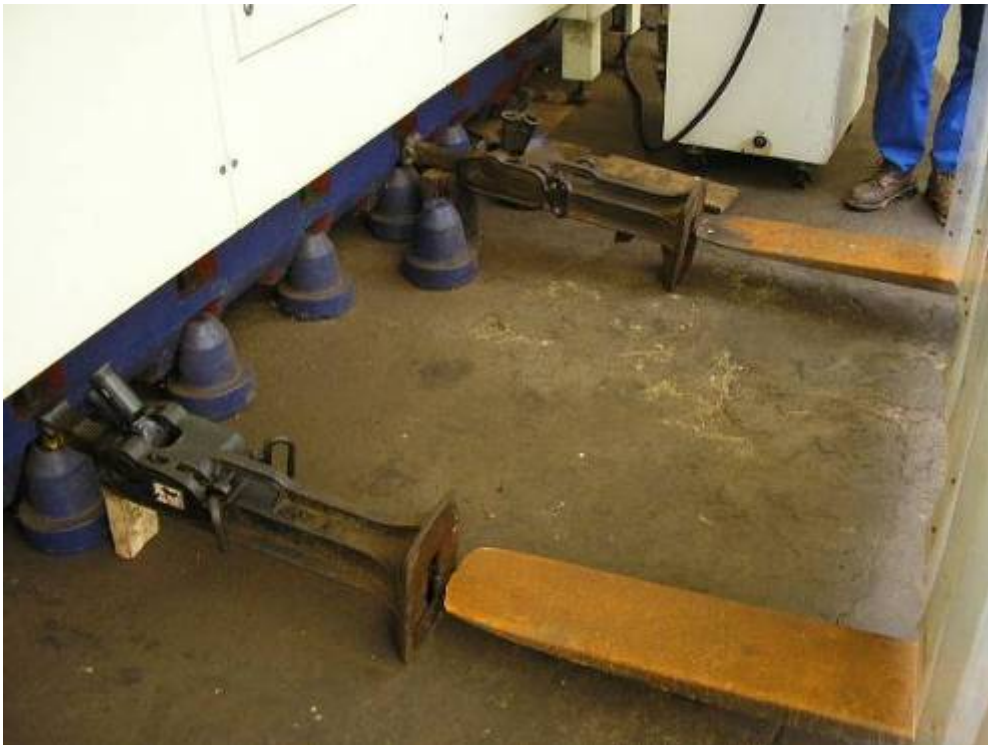
Photo18 : Hier haben wir die Stockwinden mit dem schweren Stapler abgestützt.
