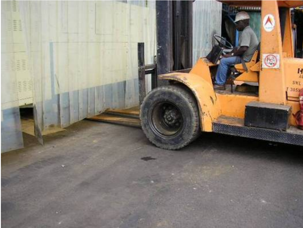
Photo17 : Dann sind wir mit dem Stapler an die Maschine gefahren und haben den als Anschlag benutzt.
