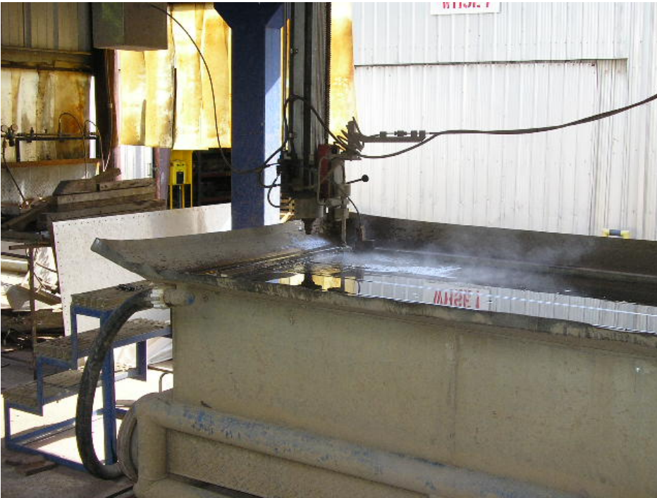
Photo: Hier die Maschine in der Produktion im 0,1 mm Bereich schneidet sie Rostfrei, Alu, Stahl u.s.w
