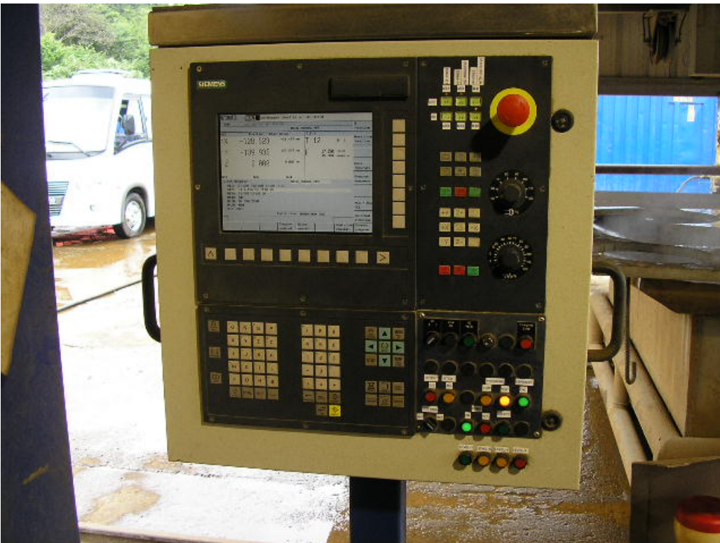
Photo: Nur die CNC Sinumerik 802DI_DMW. Ausgelegt mit Schutzlevels für die Leute, dass nicht der Lehrling gleich mit den Achsen fahren kann. Oder dass der Operator programmieren kann. Die Maschine hat 7 Schutzstufen
