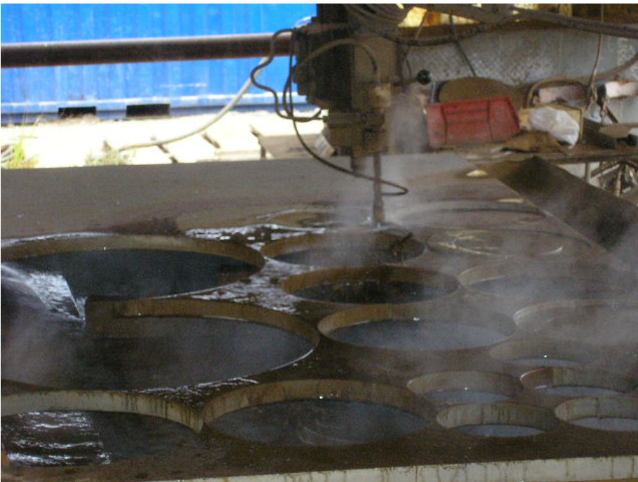
Photo: Hier schneidet man Scheiben aus. Wasserstrahl schneidet mit Wasser und etwas Sandähnlichem Gemisch, d.h. Abrasiv Material. So kann man auch gut Stahl ausschneiden, nur Wasser hätte da schon mehr Mühe. Die Wasser Hochdruck Anlage ist ein CH Produkt.
