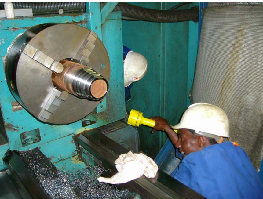
Photo: Bei der Inbetriebnahme will die Schmierung nicht so wie wir es wollen. Kein Druckaufbau. Joba sucht. Dann sieht man, dass die Pumpe defekt ist, also ein Umbau hilft auch Fehler die teure Folgen verursachen können vor dem Schaden gefunden werden.
